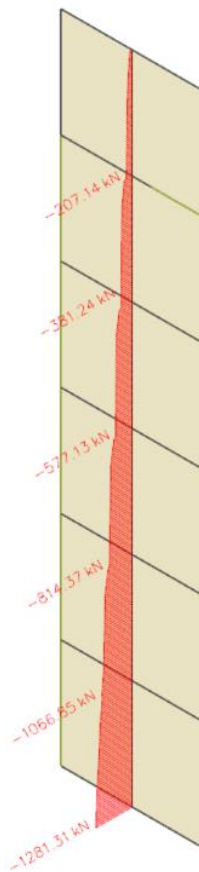
Slika 11.4. Uzdužne sile (kN)
