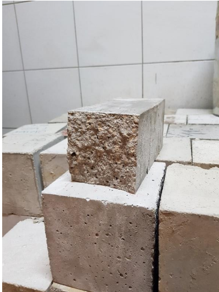
Slika 6.34. Presjek uzorka polovice prizme
