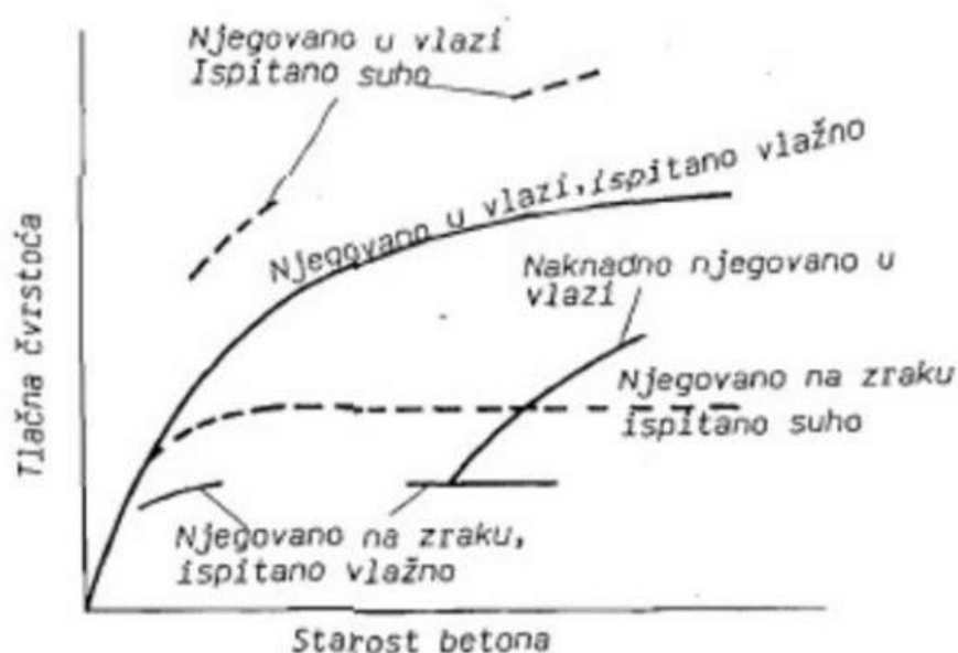
Slika 2.5. Utjecaj vlažnosti uzorka na tlačnu čvrstoću [5]
