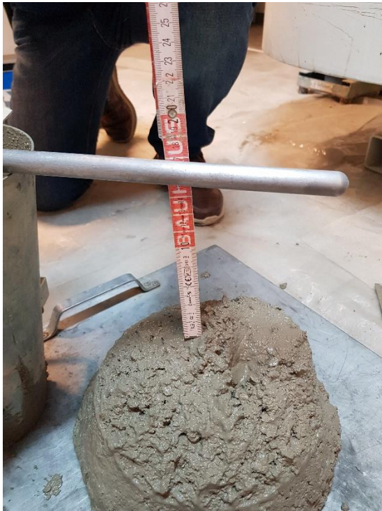
Slika 6.3. Rezultati slijeganja mješavine B2
