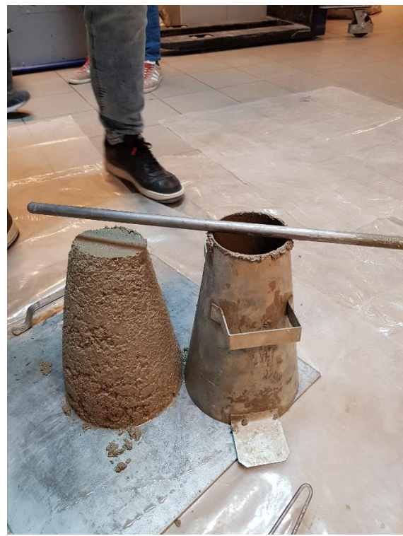
Slika 6.2. Oblik slijeganja mješavine B1
