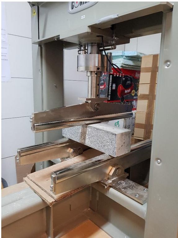
Slika 5.16. Ispitivanje čvrstoće na savijanje
