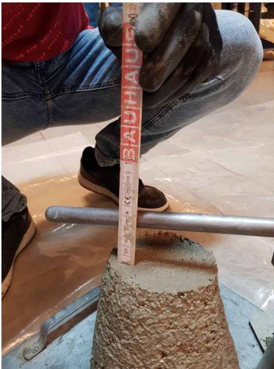
Slika 6.1. Rezultat slijeganja mješavine B1
