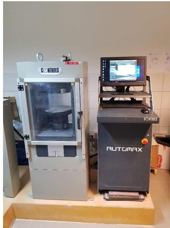
Slika 5.13. Hidraulička preša za ispitivanje uzorka kocke u laboratoriju TPA
