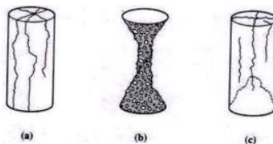
Slika 4.11. Oblici testiranih uzoraka valjka [12]
