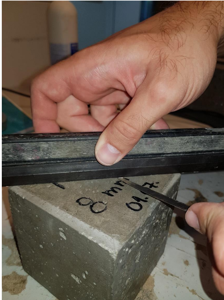
Slika 6.6. Provjera ravnosti uzoraka prema normi HRN EN 12390-1
