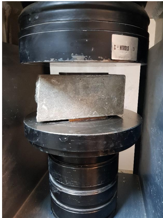
Slika 5.14. Ispitivanje tlačne čvrstoće nad polovicama prizme
