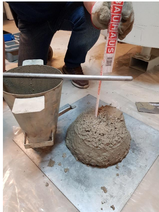
Slika 6.4. oblik slijeganja mješavine B2
