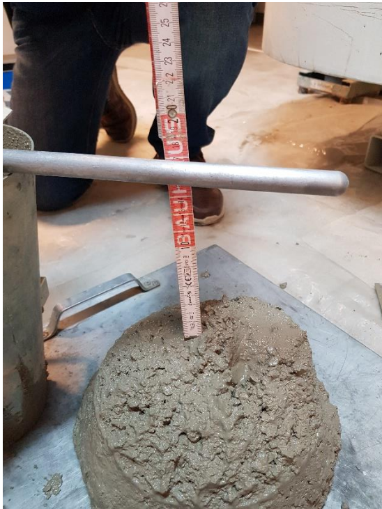
Slika 6.3. Rezultati slijeganja mješavine B2
