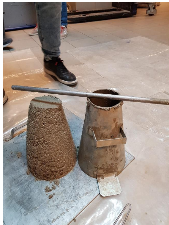
Slika 6.2. Oblik slijeganja mješavine B1
