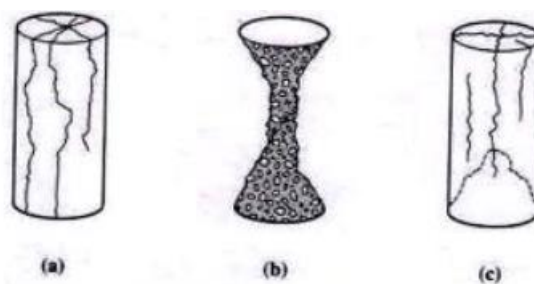
Slika 4.11. Oblici testiranih uzoraka valjka [12]
