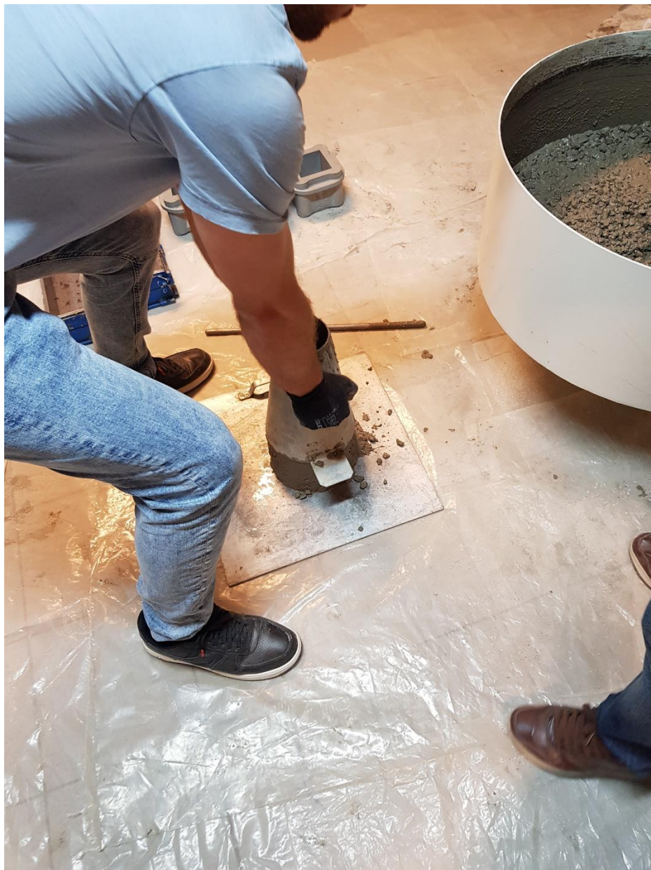
Slika 5.13. Ispitivanje konzistencije metodom slijeganja
