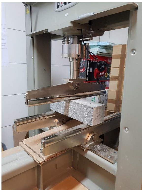
Slika 5.16. Ispitivanje čvrstoće na savijanje
