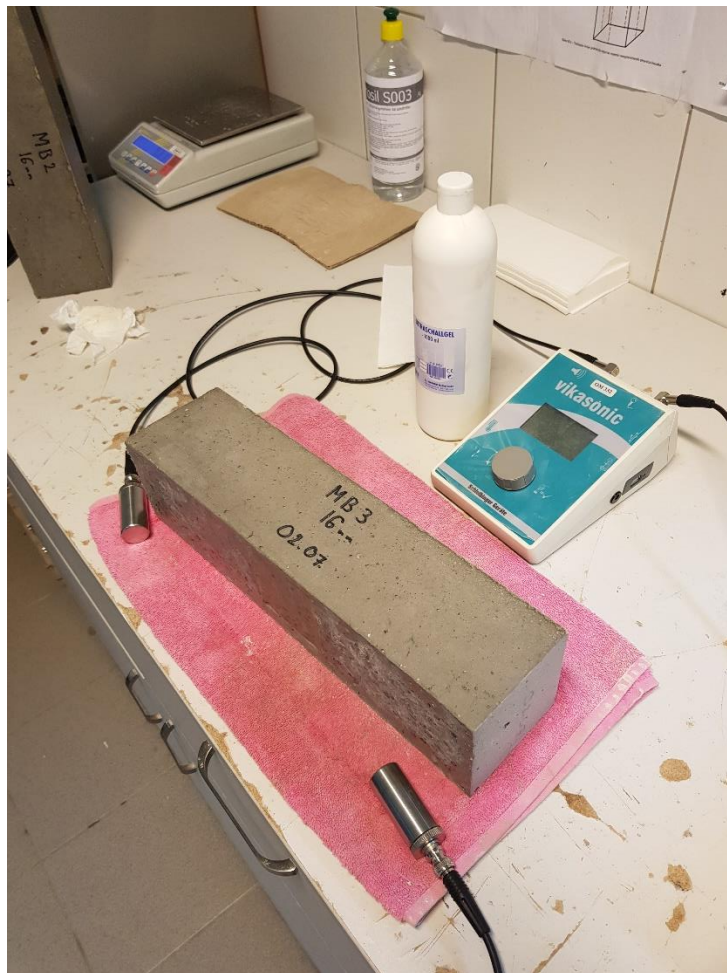
Slika 5.18. Uređaj za mjerenje brzine prolaska UZV kroz uzorak
