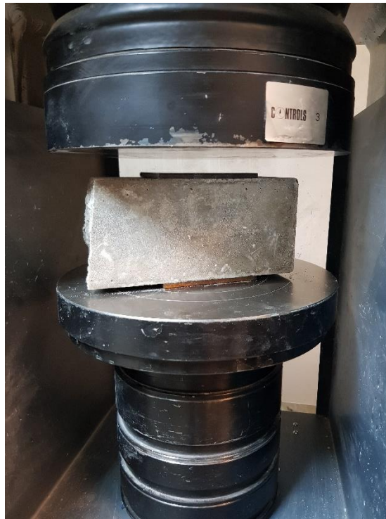
Slika 5.14. Ispitivanje tlačne čvrstoće nad polovicama prizme
