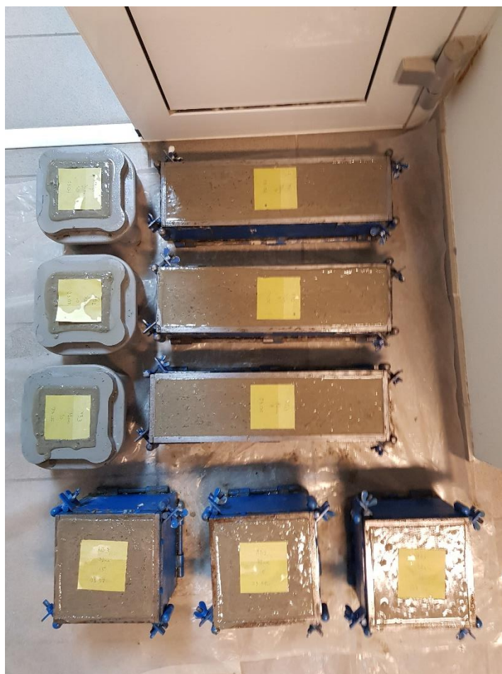
Slika 5.11. Uzorci mješavine B3(31,5mm)
