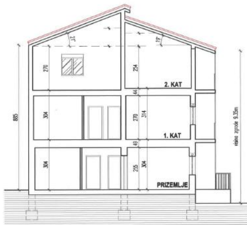
Slika 34. Presjek odabrane građevine. (Izvor – arhitektonski nacrti)
