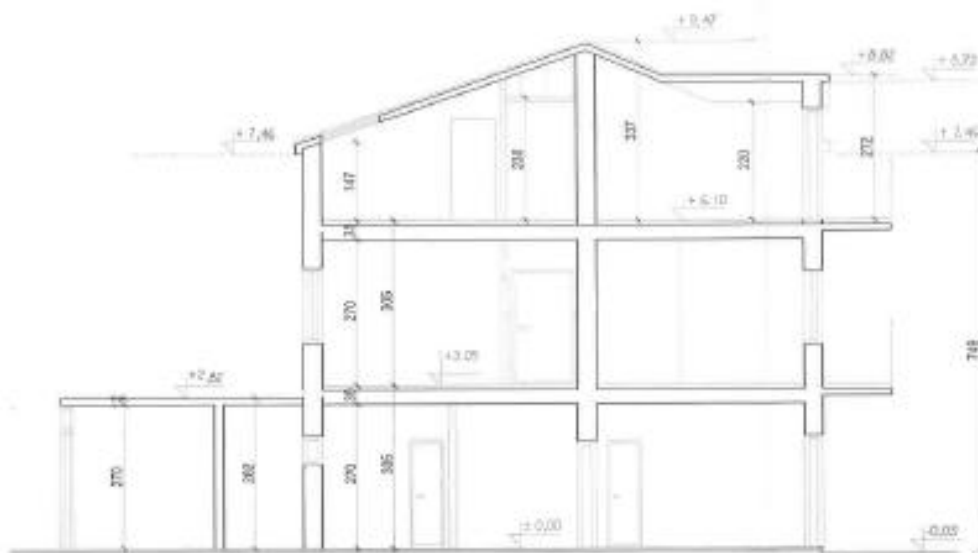
Slika 12. Presjek odabrane građevine. (Izvor – arhitektonski nacrti)
