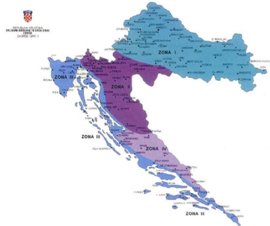
Slika 8.7 Karta karakterističnih vrijednosti opterećenja snijegom obzirom na područje
