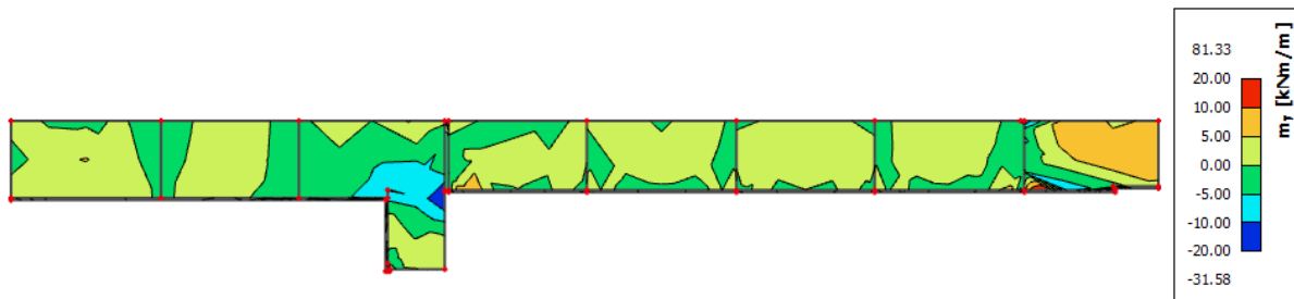
Slika 11.76 Prikaz momenata savijanja – m_y
