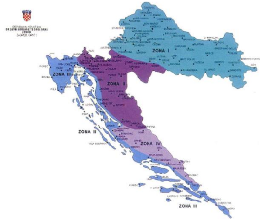
Slika 8.7 Karta karakterističnih vrijednosti opterećenja snijegom obzirom na područje
