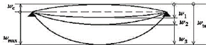
Slika 6.10 Prikaz progiba ploča
