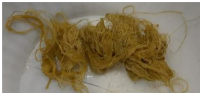
Slika 39. Odvojena vlakna spremna za sušenje [41]
