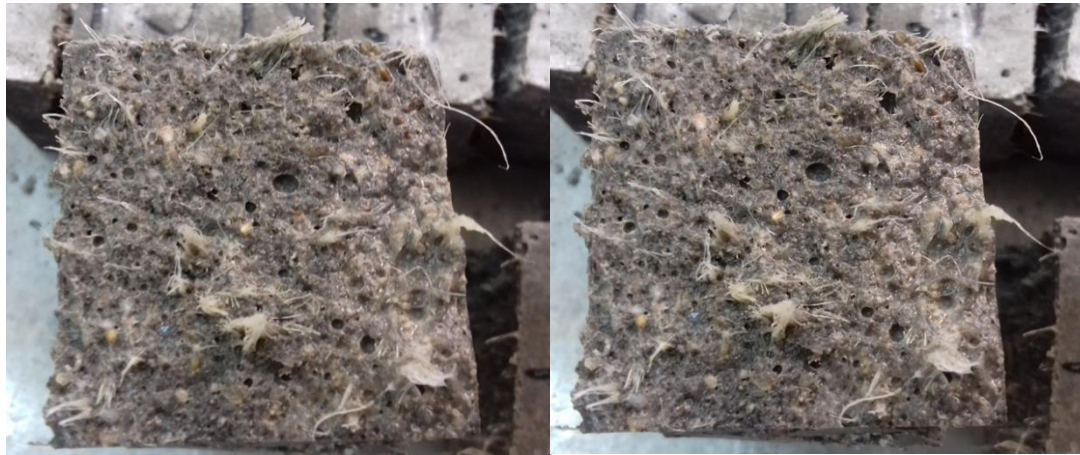
Slika 50. Presjek uzorka 19N5 -1 -1,0 nakon sloma
