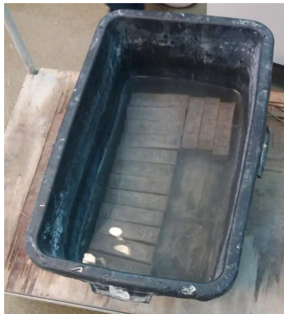
Slika 46. Uzorci njegovani u vodi do ispitivanja
