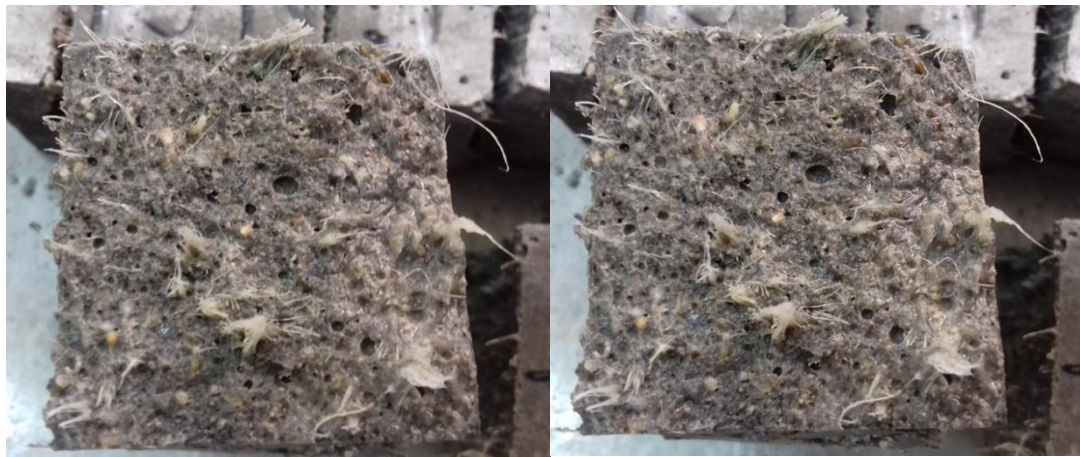
Slika 50. Presjek uzorka 19N5 -1 -1,0 nakon sloma
