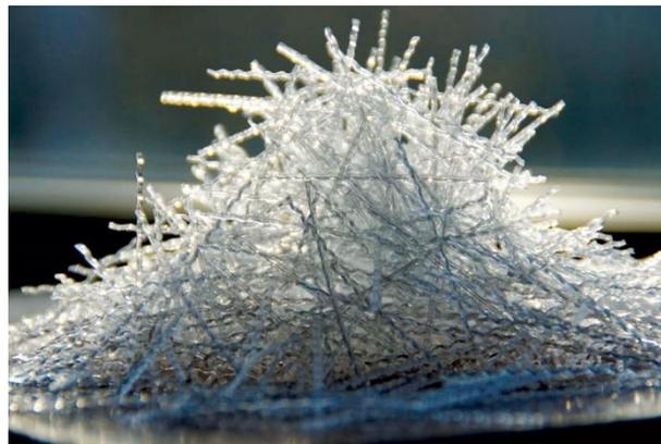
**Slika 4.** Sintetička vlakna [2]
