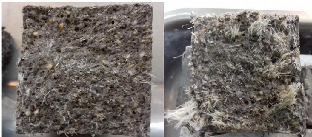
**Slika 51.** Usporedba uzoraka u odnosu na količinu i duljinu vlakana
