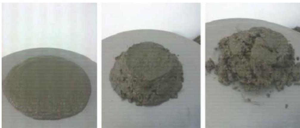
**Slika 18.** Obradivost morta bez vlakana, 0,5% vlakana, 1% vlakana [36]
