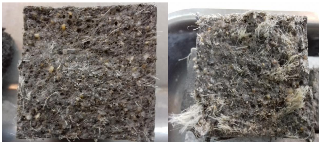
Slika 51. Usporedba uzoraka u odnosu na količinu i duljinu vlakana ( lijevo 19N5-1-0,5, desno 19N5 -3-1,0 )
