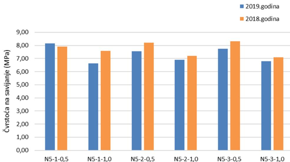
**Slika 58.** Rezultati čvrstoće na savijanje za uzorke brane 2018. [42] i 2019.
