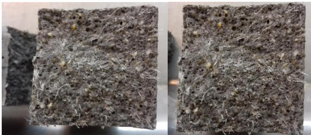
Slika 49. Presjek uzorka 19N5 -1 -0,5 nakon sloma
