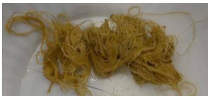
**Slika 39.** Odvojena vlakna spremna za sušenje [41]
