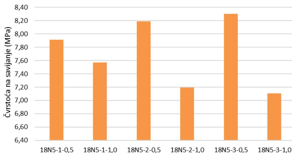
Slika 57. Čvrstoća na savijanje, rezultati iz [42]
