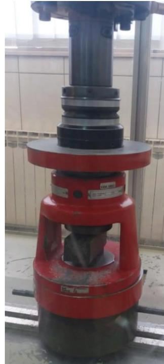
Slika 48. Hidraulička preša za tlak
