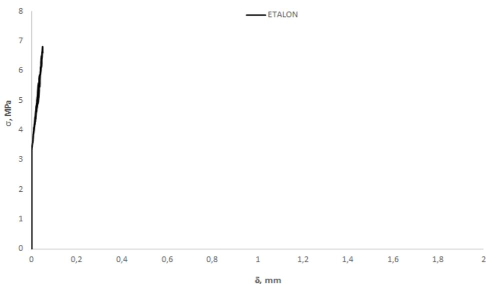
Slika 55.  $\sigma - \delta$  dijagram za uzorke etalona
