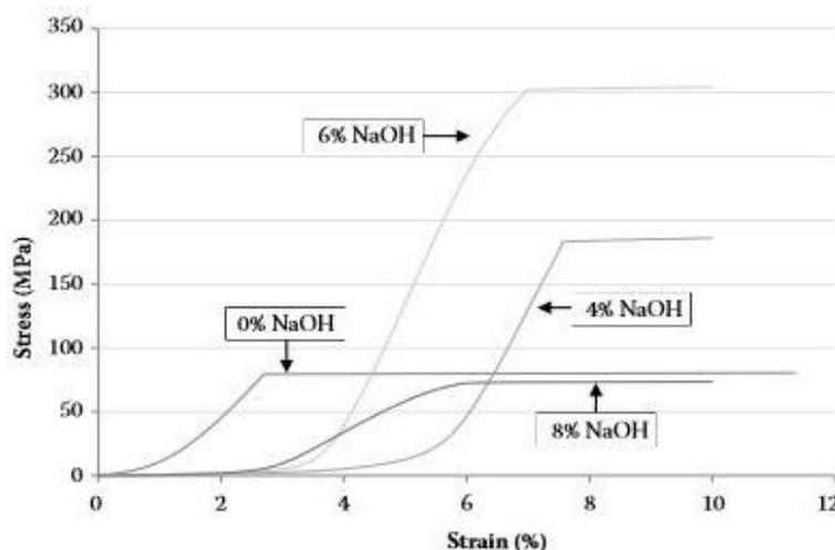
Slika 11. Dijagram naprezanje-opterećenje pri različitim koncentracijama NaOH [29]
