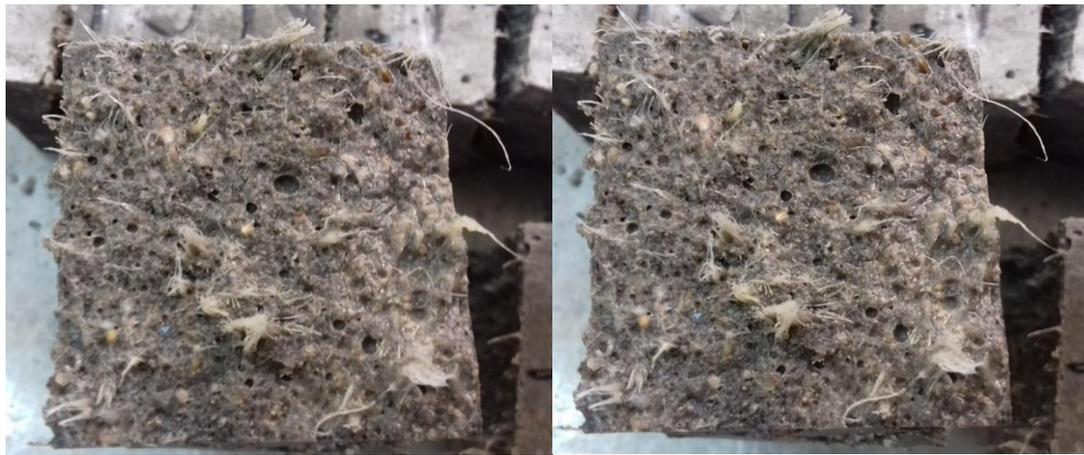
**Slika 50.** Presjek uzorka 19N5 -1 -1,0 nakon sloma
