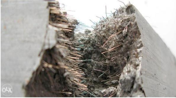
**Slika 2.** Čelična vlakna u betonu [6]
