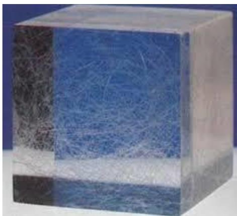
**Slika 1.** 3D raspored vlakana u betonu [5]
