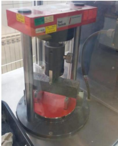
Slika 47. Hidraulička preša za savijanje
