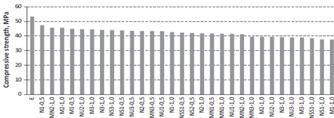
Slika 27. Usporedba tlačne čvrstoće uzoraka morta i etalona [39]
