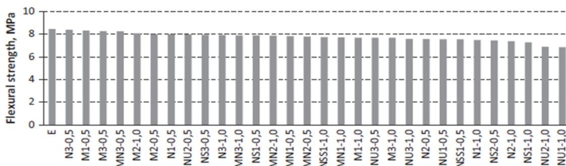
Slika 26. Usporedba savojne čvrstoće uzoraka morta i etalona [39]
