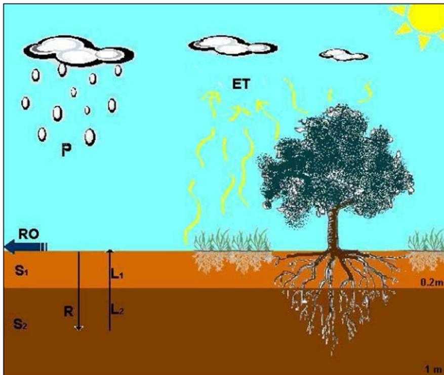
Slika 1. Shematski prikaz komponenti vodne bilance [9]
