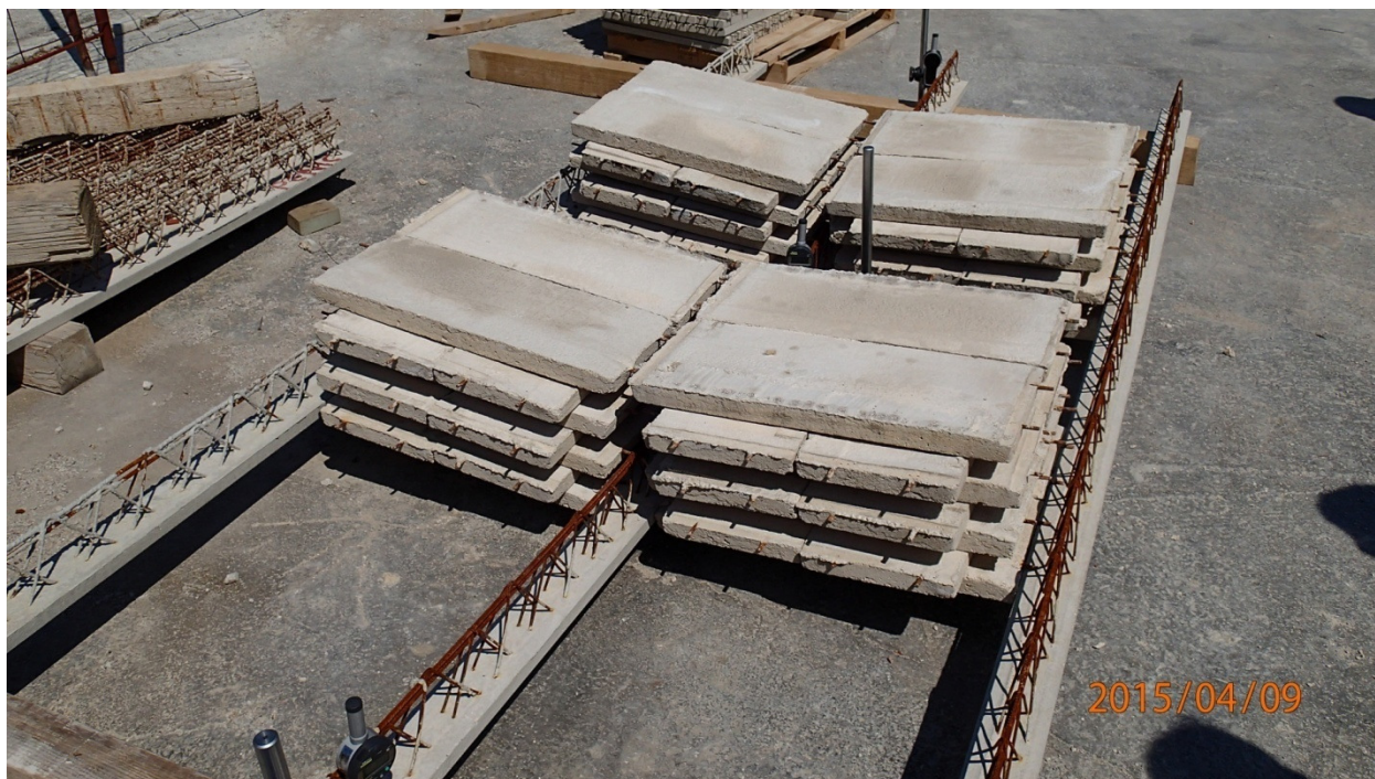
Foto 4.9: Provedba ispitivanja ( VII. faza opterećenja) – lomno opterećenje
