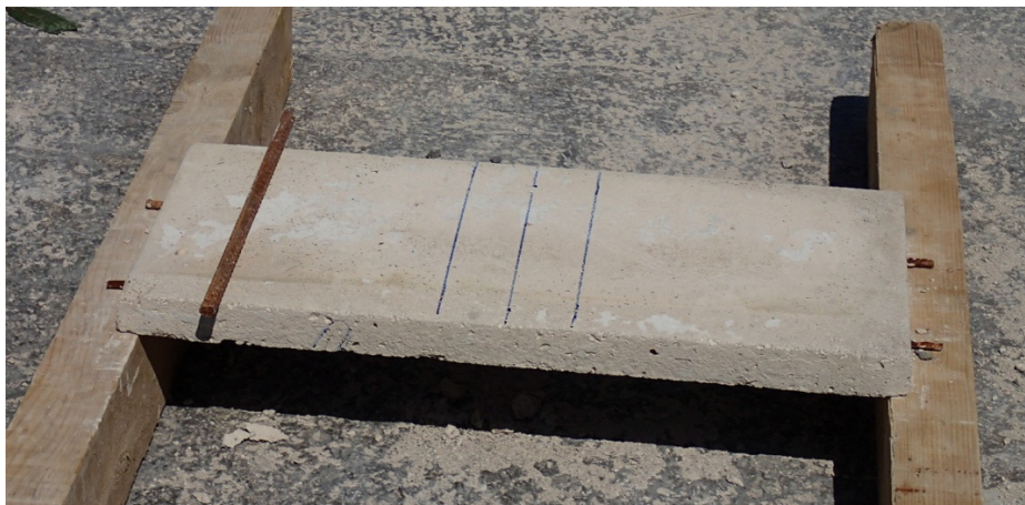
Foto 4.17: Priprema za opterećivanje poklopnice na posmičnu nosivost
