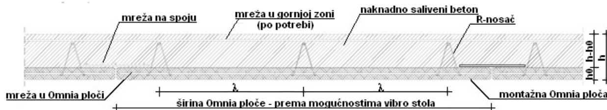
Slika 2.2: Poprečni presjek stropa sustava Omnia
