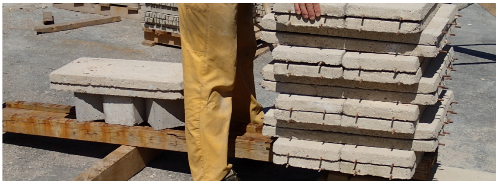
Foto 4.20: Nanošenje opterećenja na poklopticu za ispitivanje na posmičnu nosivost
