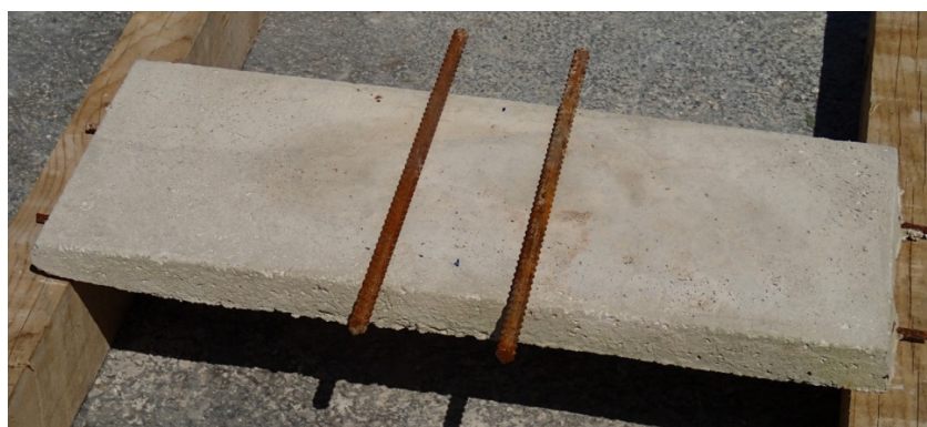
Foto 4.15. Priprema za opterećivanje poklopnice
