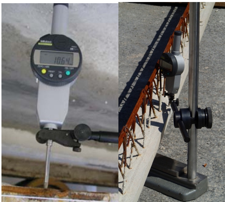
Foto 4.4: Digitalna Mikrourica Mitutoyo Absolute
