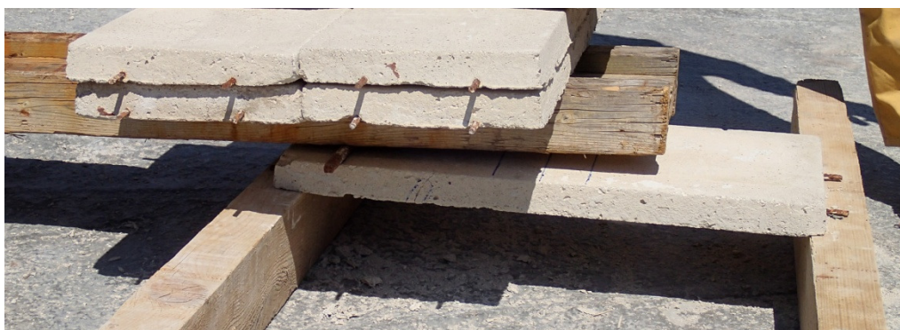
Foto 4.19: Početak nanošenja opterećenja na poklopticu za ispitivanje na posmičnu nosivost
