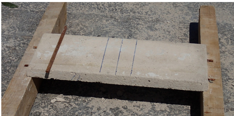
Foto 4.17: Priprema za opterećivanje poklopnice na posmičnu nosivost
