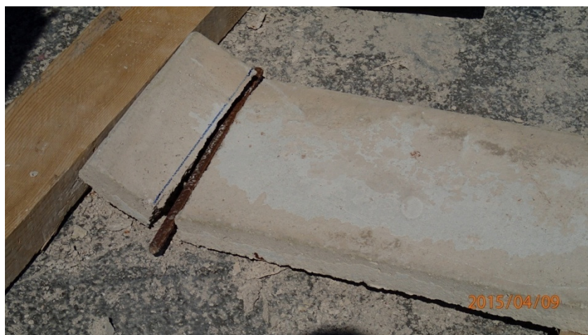
Foto 4.22: Izgled mjesta sloma poklopnice pri ispitivanju posmične čvrstoće
