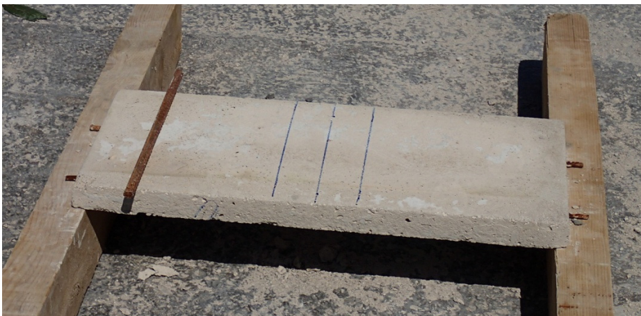
Foto 4.17: Priprema za opterećivanje poklopnice na posmičnu nosivost
