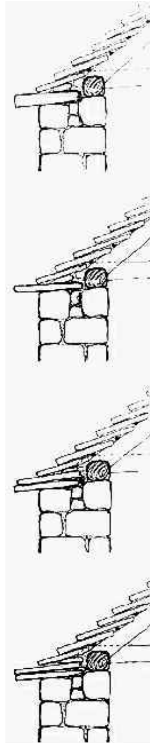
Grafički prilog 53. Jednostruke (debela, obična) i dvostruke strehe (s uvučenim gornjim redom, obična) / iz Tradicijska kamena kuća dalmatinskog zaleđa, Z. Živković
