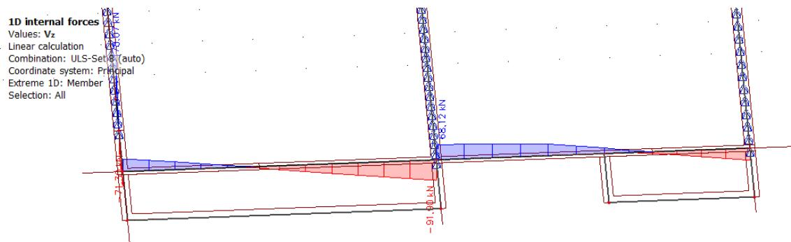
Slika 99 Dijagram poprečnih sila  $V_z$  na gredama
