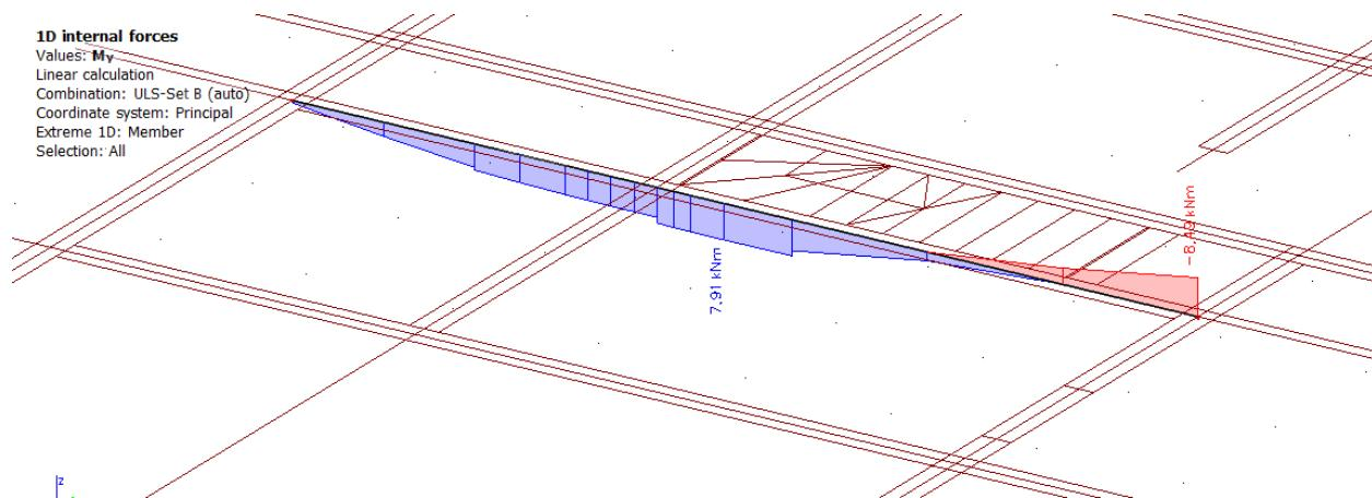
Slika 83 Dijagram momenata savjيانja  $M_y$  na gredama
