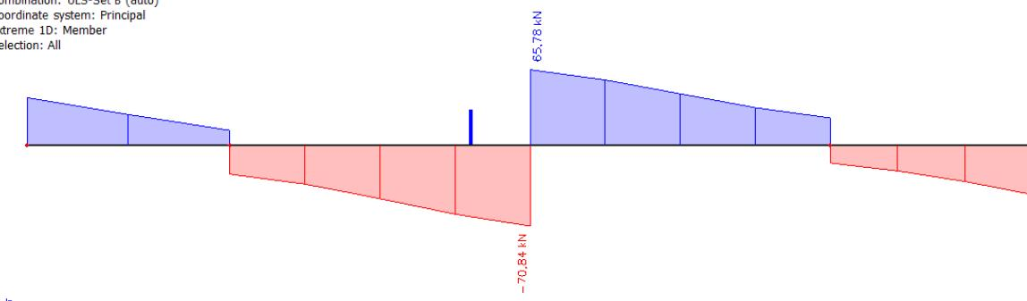
Slika 78 Dijagram poprečnih sila  $V_z$  na gredama**Poprečni presjek grede:**
