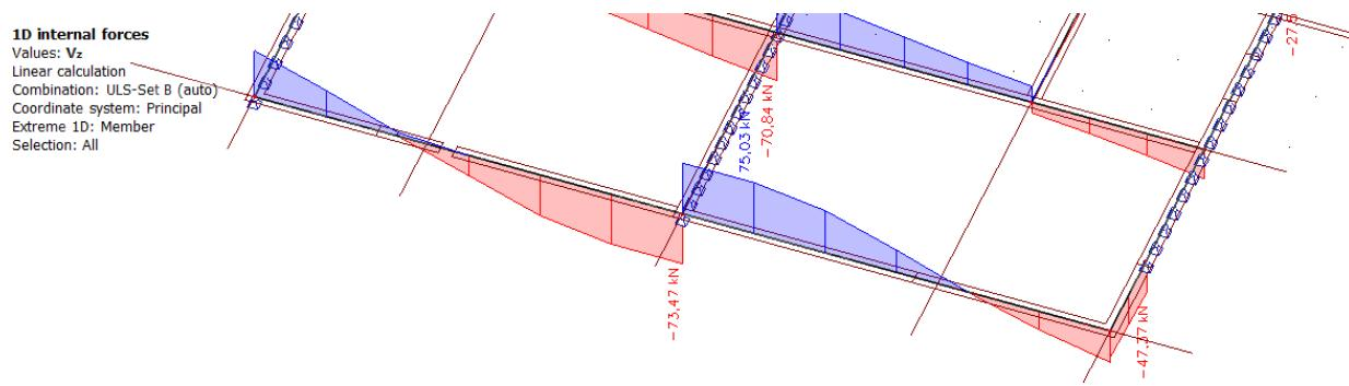
Slika 80 Dijagram poprečnih sila  $V_z$  na gredama**Poprečni presjek grede:**
