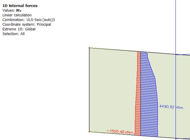
Slika 158 Maskimalni moment savijanja
