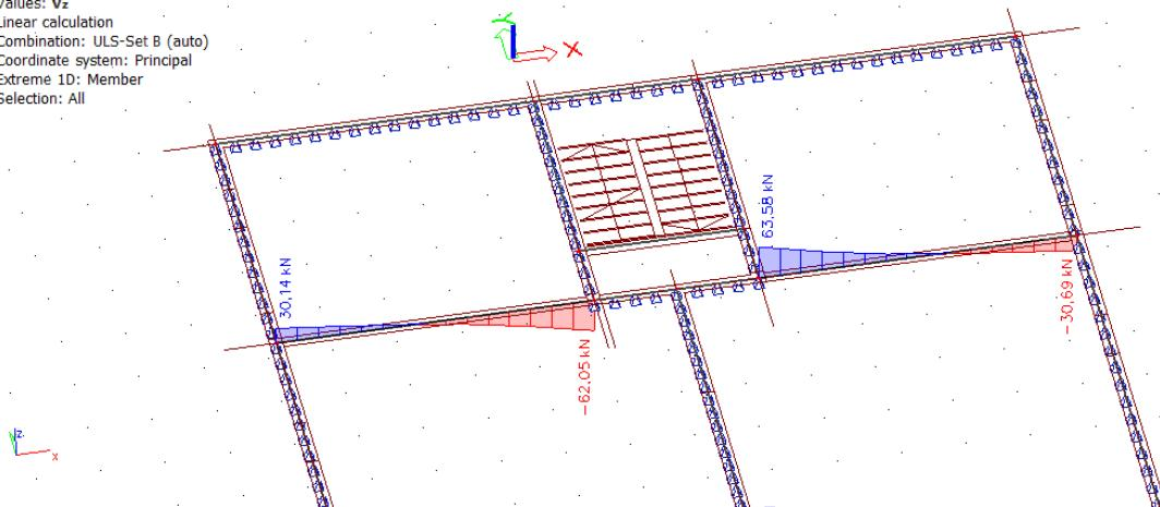
Slika 97 Dijagram poprečnih sila  $V_z$  na gredama
