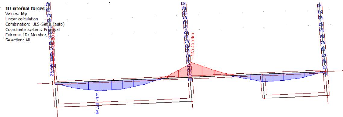
Slika 98 Dijagram momenata savjjanja  $M_y$  na gredama
