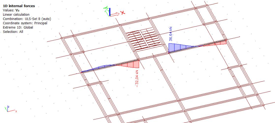
Slika 114 Dijagram poprečnih sila  $V_z$  na gredama
