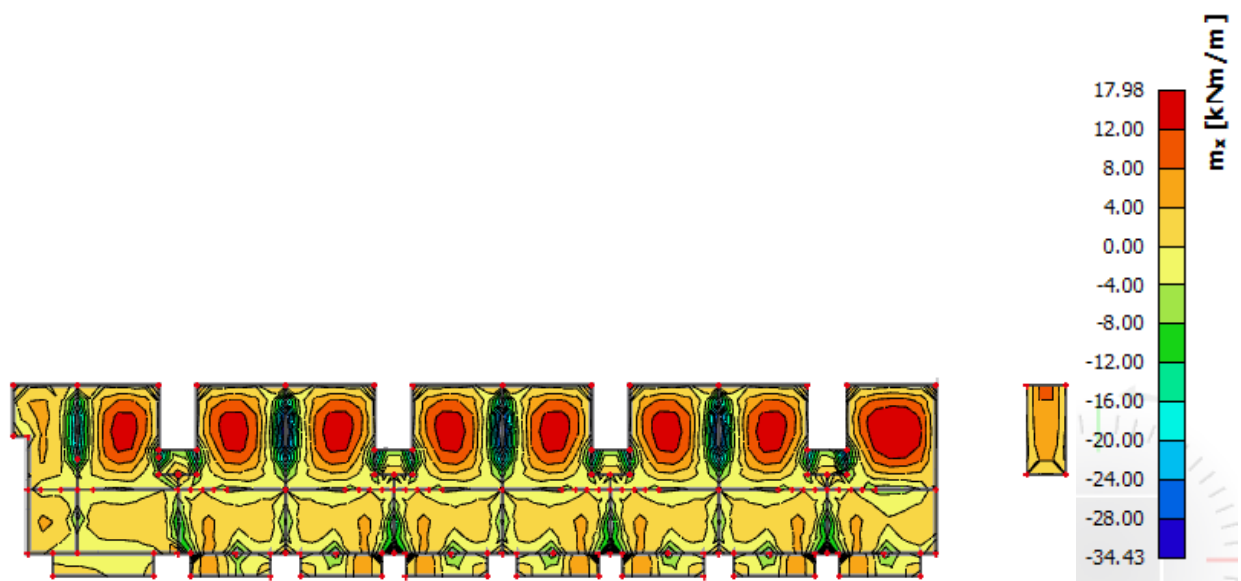
Slika 11.37. Rezultati momenata savijanja ploče pozicije 300 (GSN 2, M_x )
