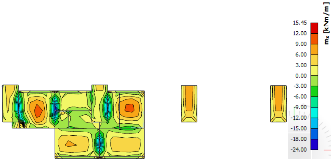
Slika 11.5. Rezultati momenata savijanja ploče pozicije 700 (GSN 2, M_x )
