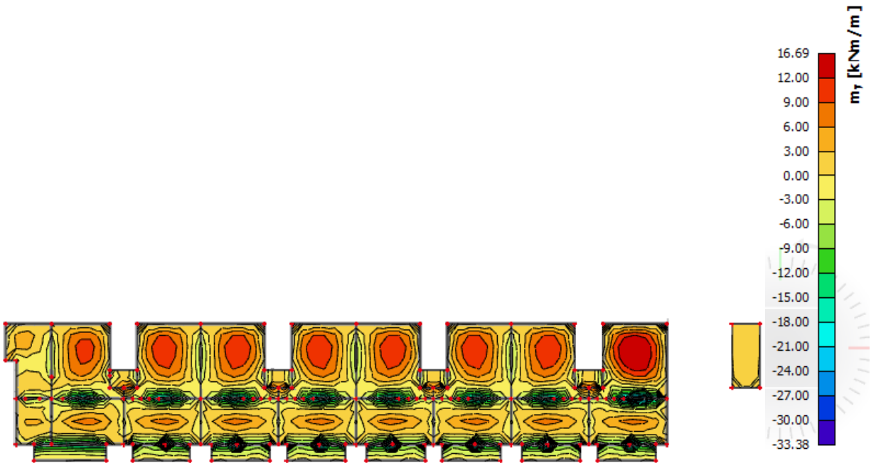
Slika 11.36. Rezultati momenata savijanja ploče pozicije 300 (GSN 2, M_y )
