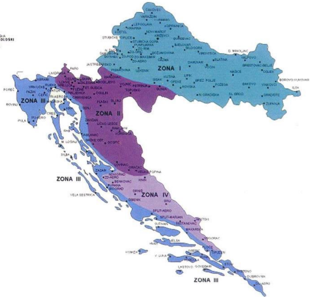
Slika br.29 Klimatske zone karakterističnog opterećenja snijegom [14]
