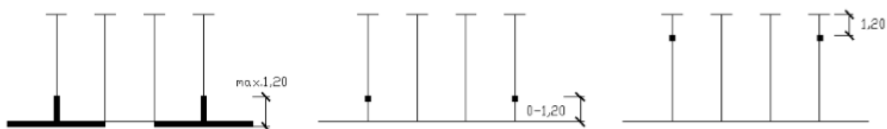
Slika 2. Odnos položaja stupa/nosivog zida i parkirnog mjesta, [2]
