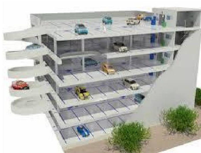
Slika 5. Rampe kod višetažnih garaža, [4]
