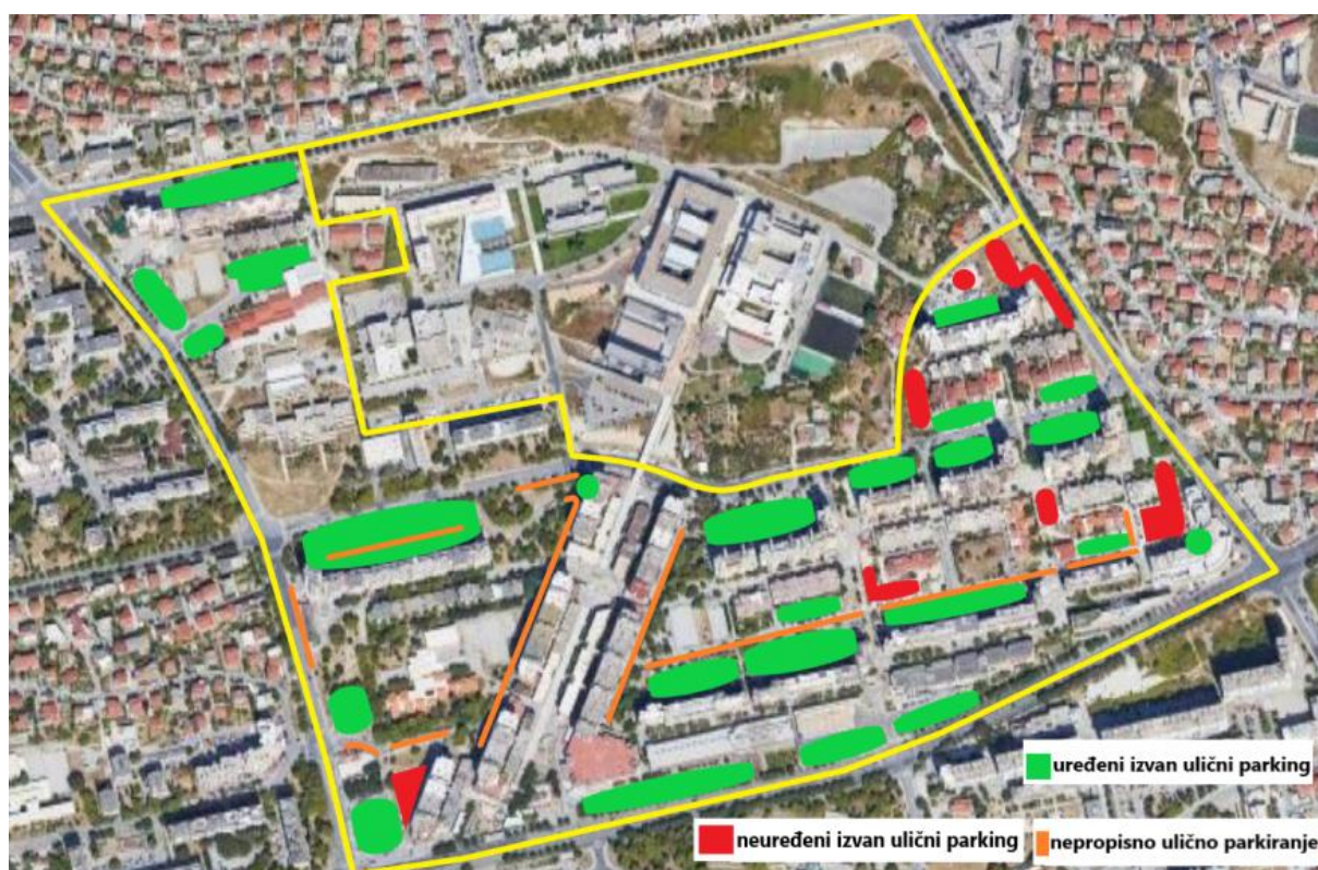
Slika 46. Prikaz uličnih i izvan uličnih parkirališnih površina
