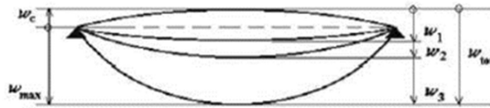
Slika 7.3 Prikaz progiba grede
