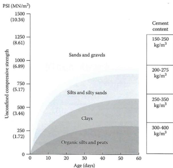
Slika 7: Jednoosna tlačna čvrstoća u ovisnosti o čvrstoći materijala
