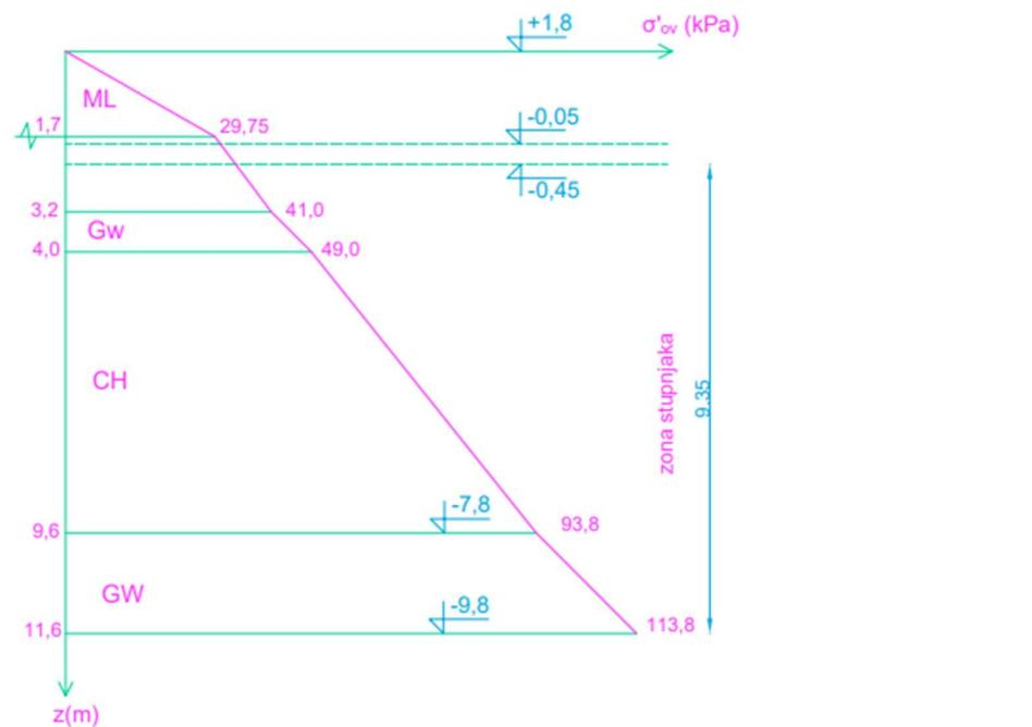
Slika 5: Prikaz pripadajućeg dijagrama vertikalnog efektivnog naprezanja za B – 2
