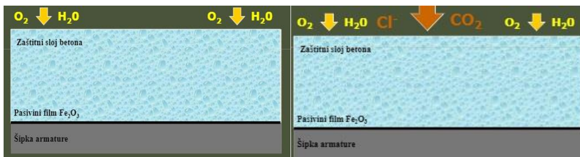
Slika 2.7 Pasivizacija (lijevo), Depasivizacija (desno)
