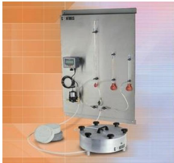
Slika 5.3 Uredaj za ispitivanje plino-propusnosti betona
