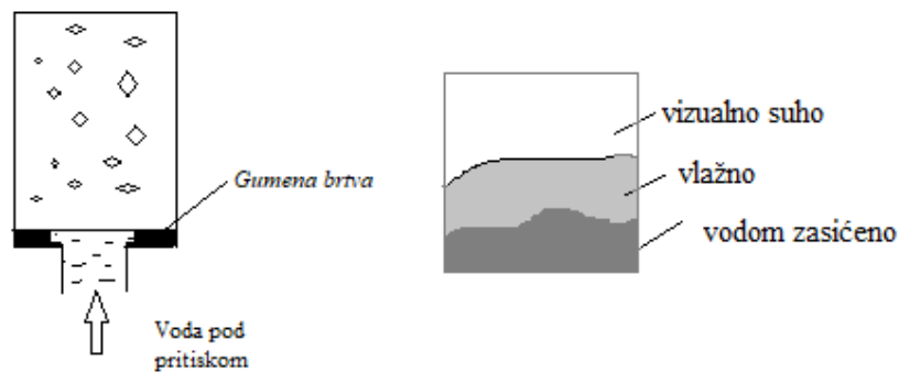
Slika 5.2 Shematski prikaz ispitivanja vodo-nepropusnosti betona i izgled prelomljenog tijela 20x20 cm
