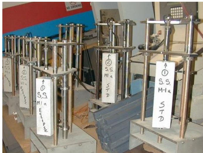
Slika 26. Prikaz više istovremenih testova skupljanja koristeći LVDT [12]
