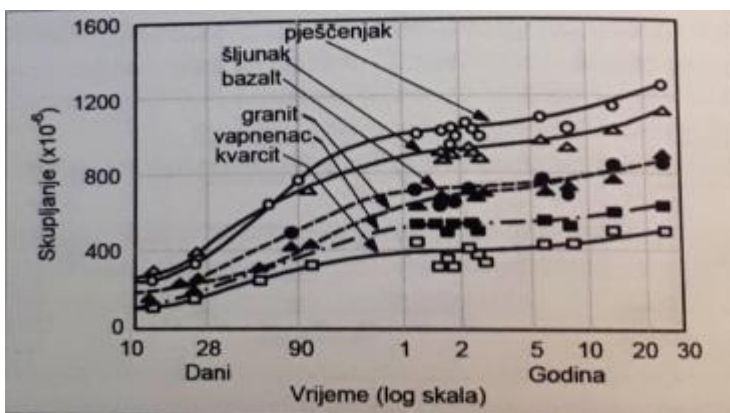
Slika 23. Skupljanje betona istih satava ali različitih agregata [5]
