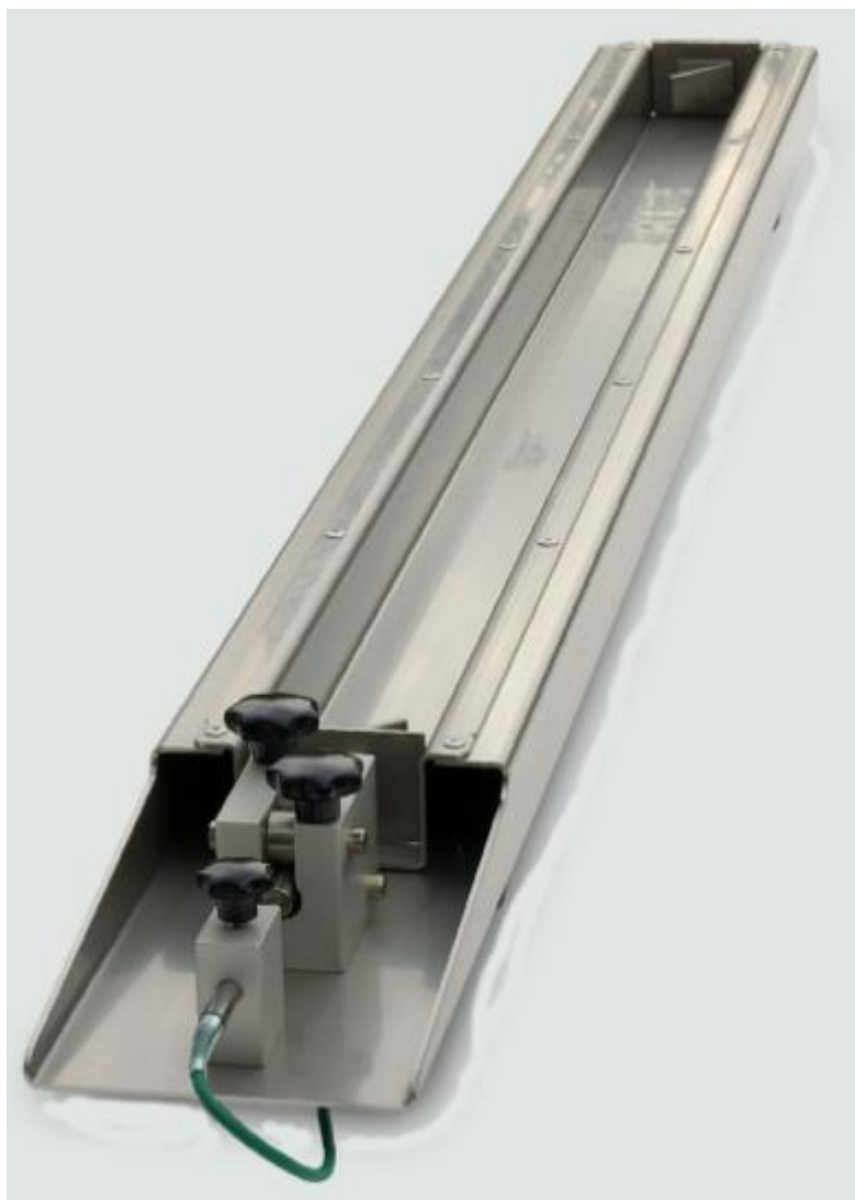
Slika 29. Odvod za mjerenje skupljanja betona [11]
