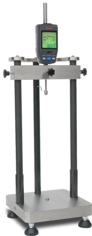
Slika 28. Uređaj za mjerenje skupljanja betona [11]
