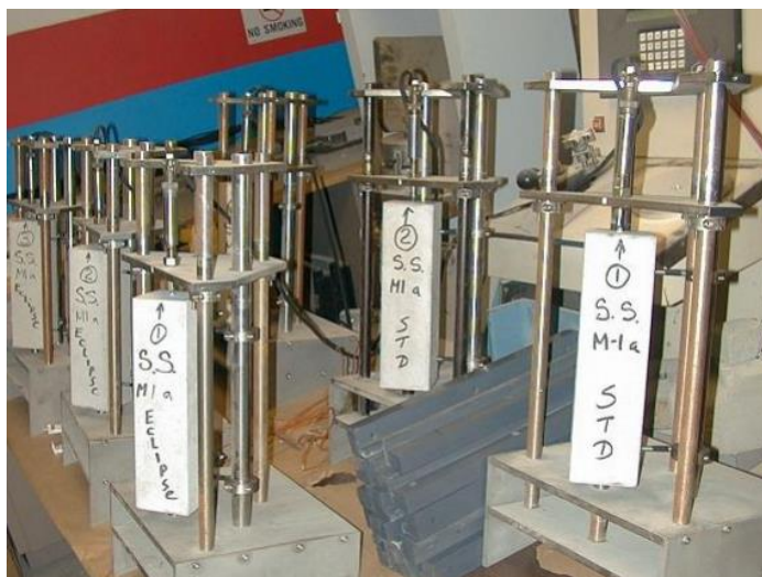
Slika 26. Prikaz više istovremenih testova skupljanja koristeći LVDT [12]
