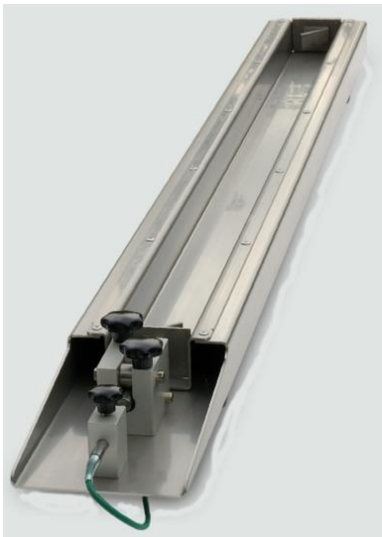
Slika 29. Odvod za mjerenje skupljanja betona [11]
