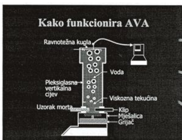
Slika 5.5 Shematski prikaz djelovanja analizatora zračnih pora [7]
