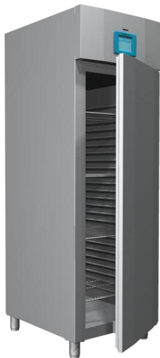
Slika 5.1 Uredaj za ispitivanje otpornosti betona ciklusima smrzavanja i odmrzavanja [9]
