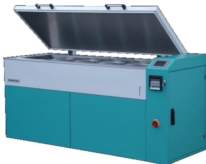
Slika 5.2 Uredaj za ispitivanje otpornosti betona ciklusima smrzavanja i odmrzavanja [9]
