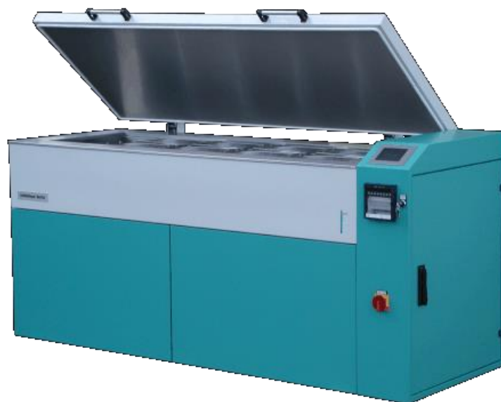
Slika 5.2 Uređaj za ispitivanje otpornosti betona ciklusima smrzavanja i odmrzavanja [9]
