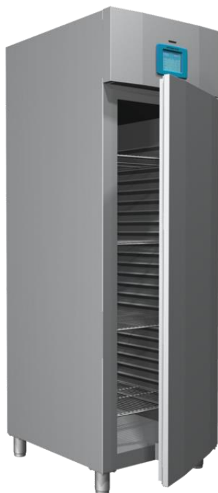
Slika 5.1 Uređaj za ispitivanje otpornosti betona ciklusima smrzavanja i odmrzavanja [9]
