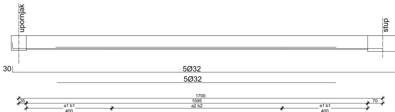
Slika 32. Prikaz armiranja uzdužnog nosača u polju
