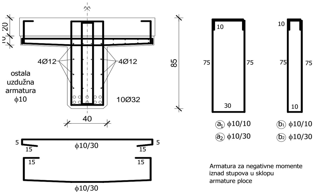
Armatura za negativne momente iznad stupova u sklopu armature ploče
