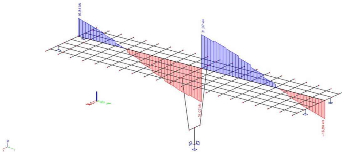
Slika 12. Dodatno stalno opterećenje-poprečne sile ( $V_z$ ) u  $\text{kN}$
