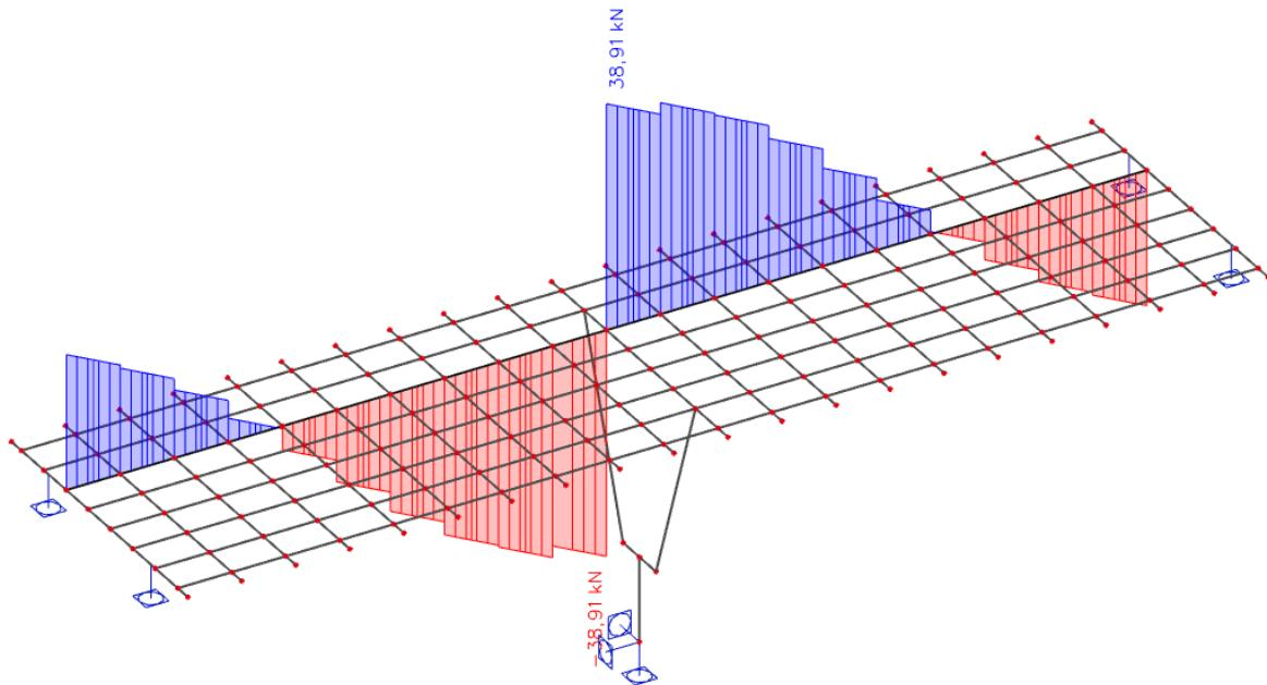
*Slika 12. Dodatno stalno opterećenje – dijagram poprečne ( $V_z$ ) sile u kN*
