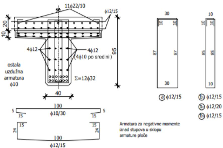
*Slika 32. Prikaz armiranja nosača u presjeku a-a*
