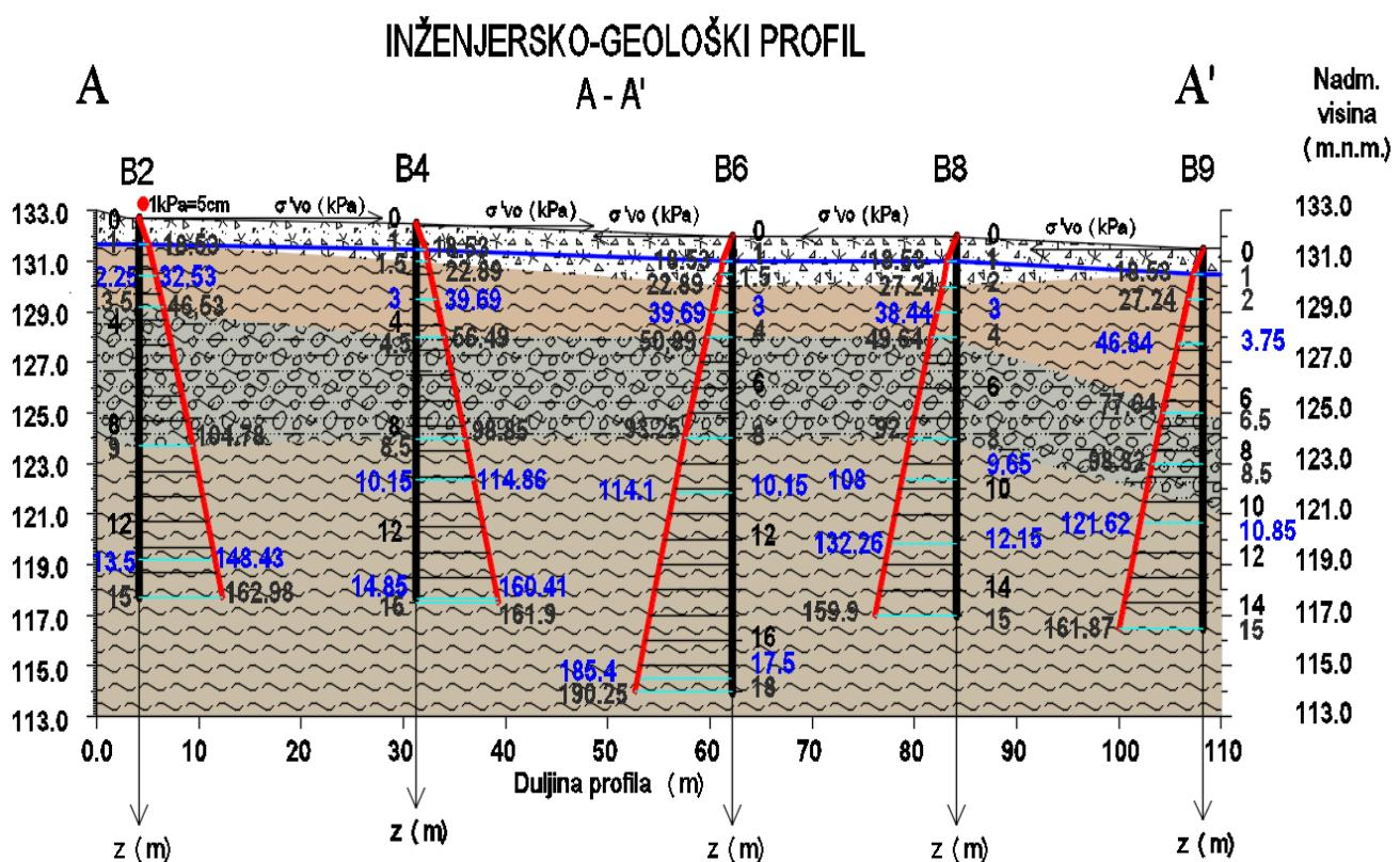
**SLIKA 7.** Dijagram vertikalnog efektivnog naprezanja po dubini
