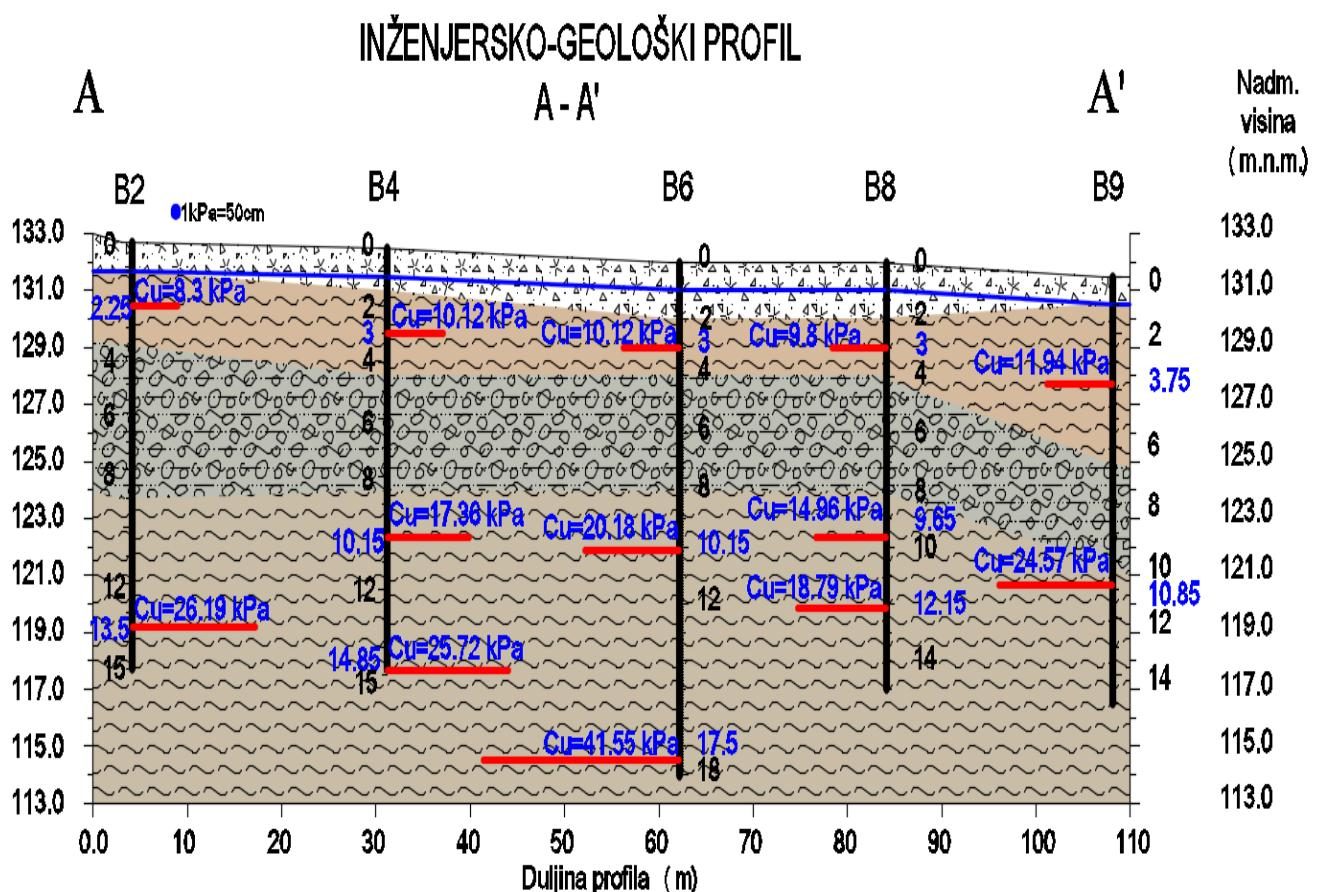
SLIKA 8. Dijagram nedrenirane čvrstoće (Cu) po dubini
