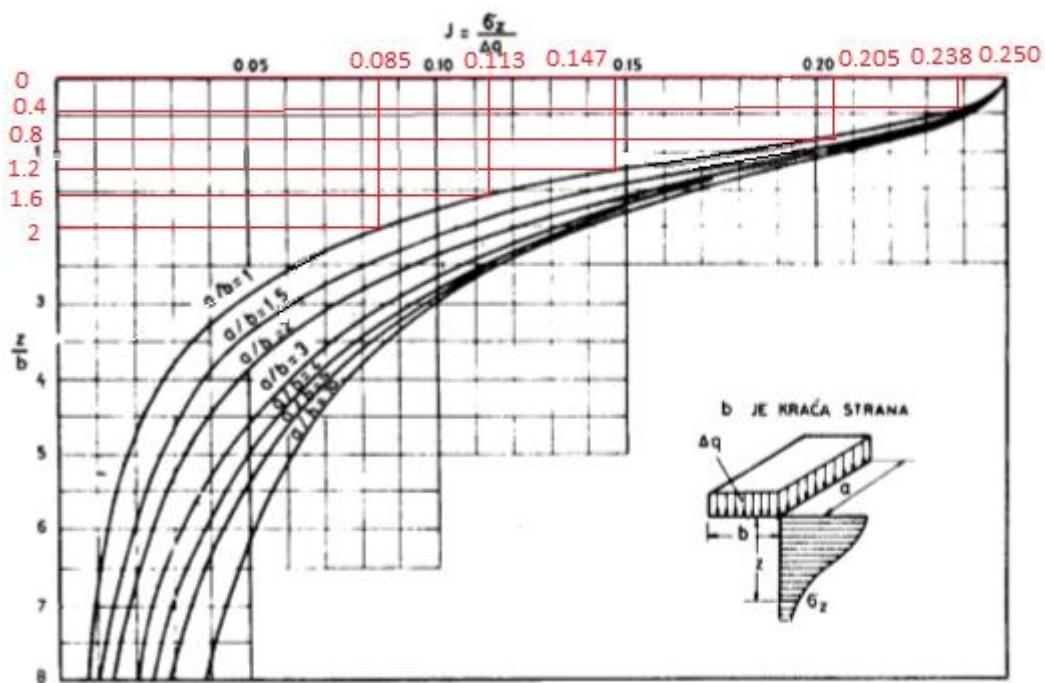
**SLIKA 14.** Steinbrennerov dijagram za proračun uspravnih dodatnih naprezanja
