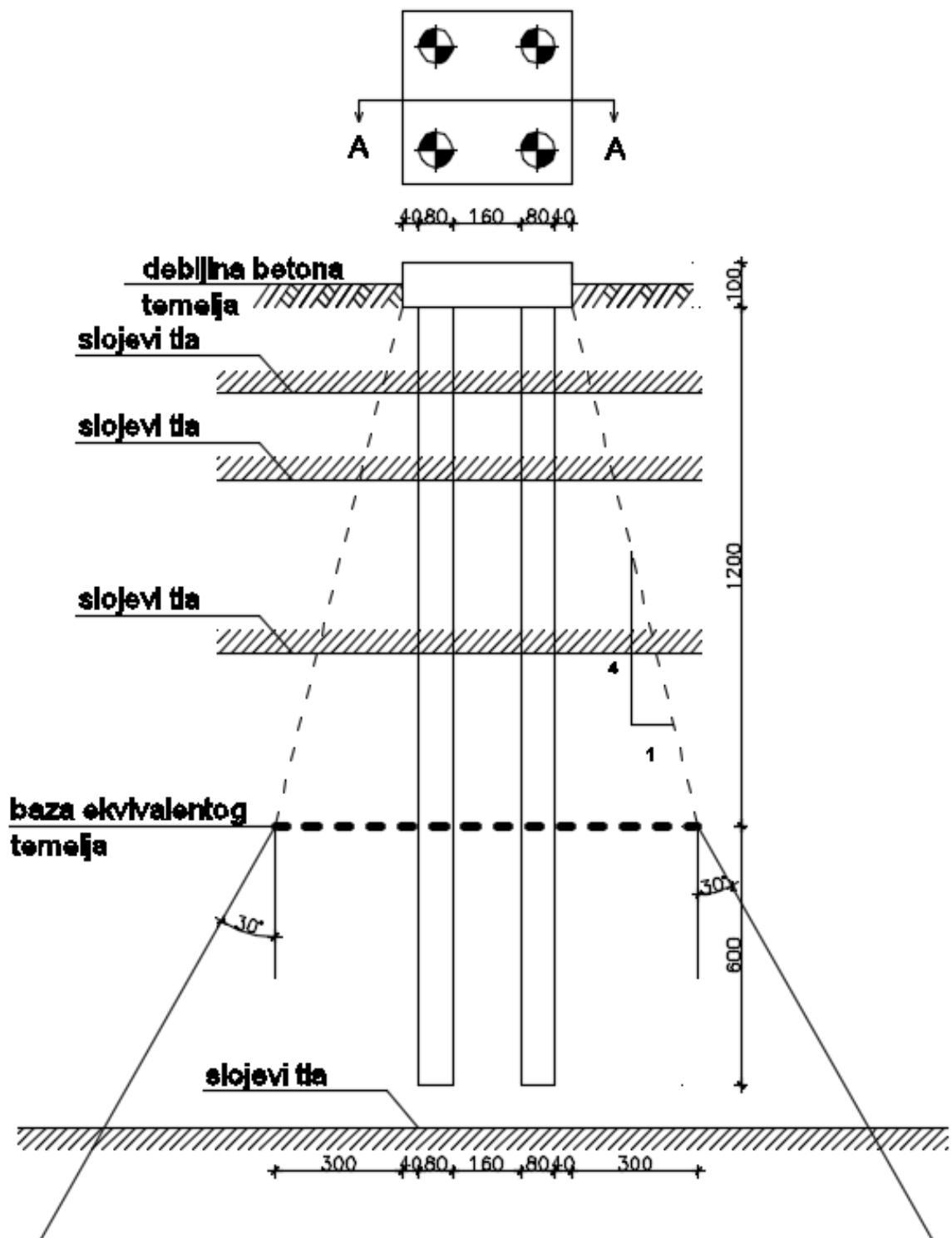
**Slika 12.** Raspodjela uspravnog naprezanja ispod grupe pilota M 1:100
