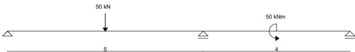
Slika 3.2. Statiki neodređen sustav
