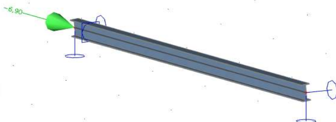
Slika 35 Model krovne podrožnice za djelovanje uzdužne sile.
