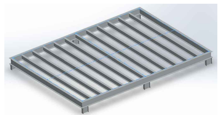
međukatna čelična konstrukcija
