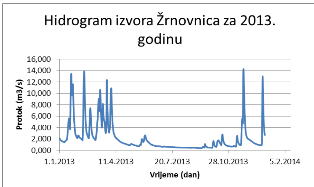
Slika 3.10.: Hidrogram za rijeku Žrnovnicu za 2013. godinu
