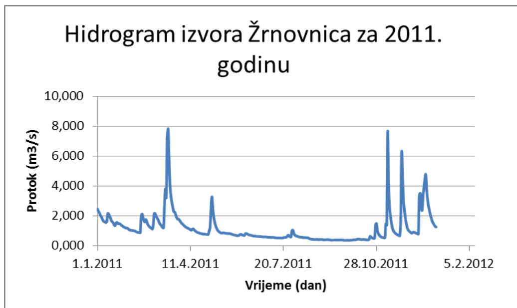
Slika 3.8.: Hidrogram za rijeku Žrnovnicu za 2011. godinu
