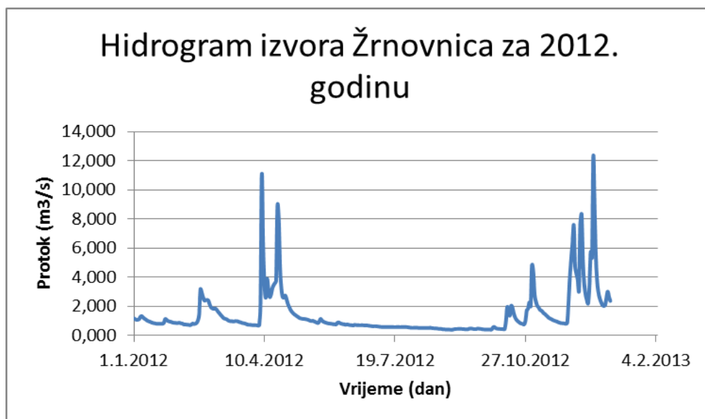
Slika 3.9.: Hidrogram za rijeku Žrnovnicu za 2012. godinu
