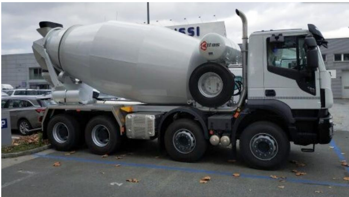
Slika 4.8 - Kamion sa miješalicom za beton IVECO AD340X42Z HR OFF
