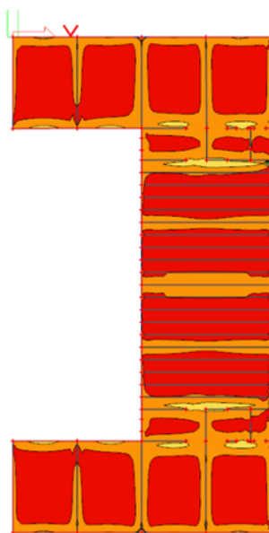
Slika 6.1.3 Moment savijanja M_{Ed,y} (kNm/m) za GSN-1
