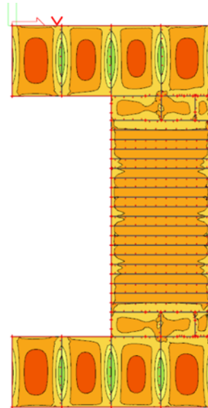
Slika 6.1.8 Moment savijanja M_{Ed,x} (kNm/m) za GSU-1
