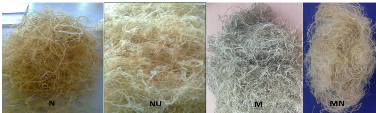
Slika 25. Uzorci vlakana N, NU, M i MN dobivena ovisno o metodi maceracije [19]
