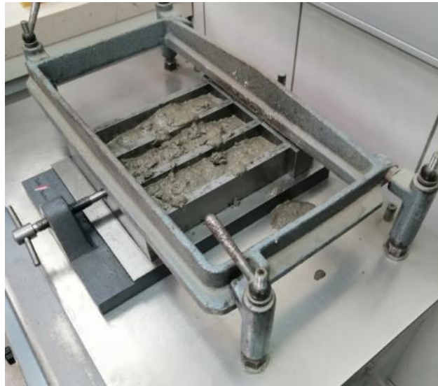
Slika 46. Vibrostol sa trodijelnim kalupom i mješavinom
