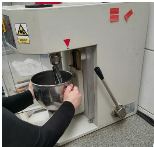
Slika 44. Standardna laboratorijska miješalica i posuda sa mortom
