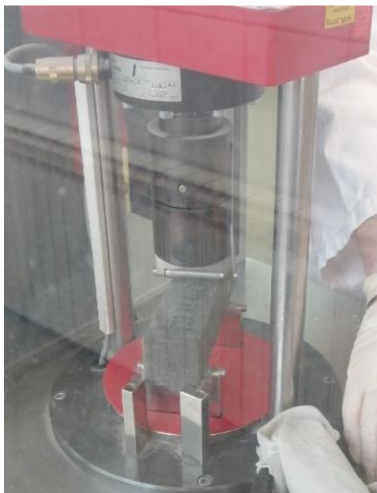
Slika 49. Ispitivanje čvrstoće na vlak (savijanjem)
