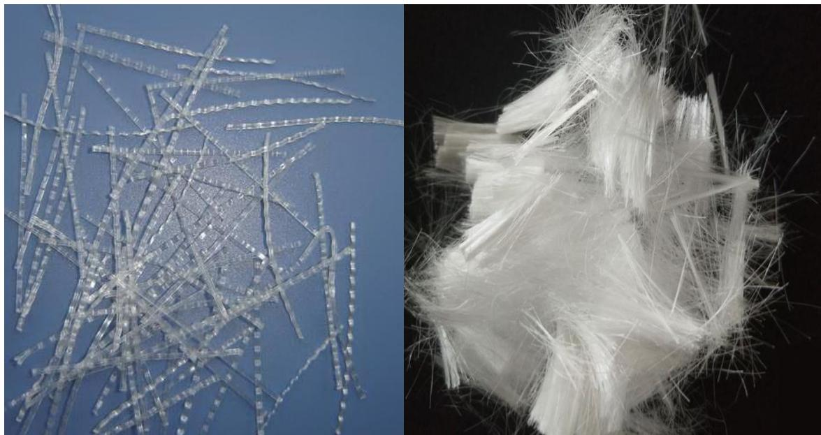
Slika 2. Sintetička vlakna [6,7]
