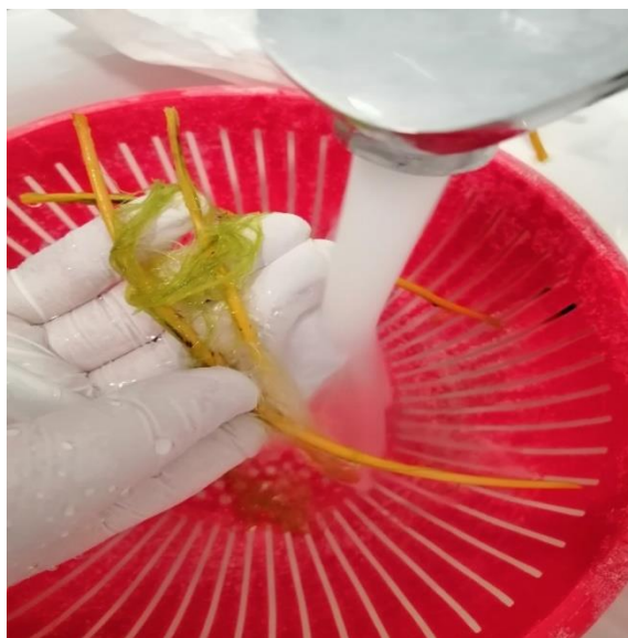
Slika 37. Vlakna nakon tretiranja u mikrovalnoj pećnici (lijevo). Odvajanje vlakana brnistre pod mlazom hladne vode iz slavine (desno)
