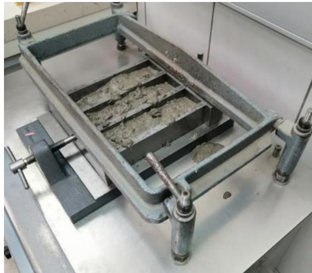
*Slika 46. Vibrostol sa trodijelnim kalupom i mješavinom*
