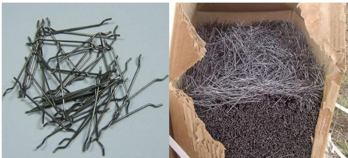
Slika 3. Čelična vlakna [6,7]
