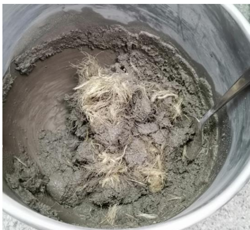
Slika 45. Ručno miješanje vlakana i morta
