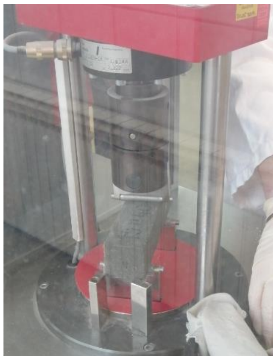
Slika 49. Ispitivanje čvrstoće na vlak (savijanjem)
