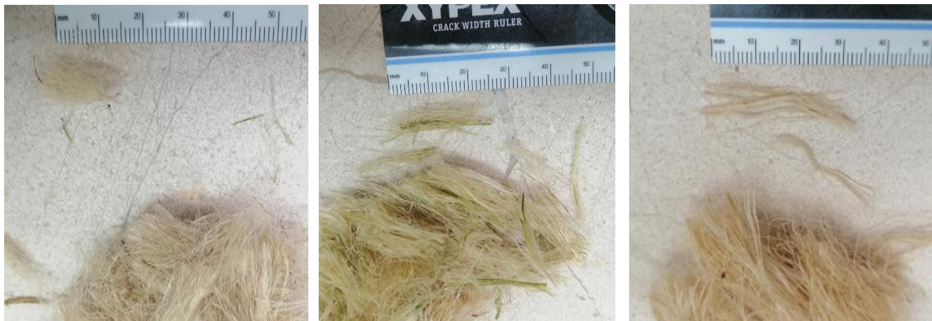
Slika 39. Osušena i izrezana vlakna spremna za ispitivanje, na duljine od 1,2,3 cm
