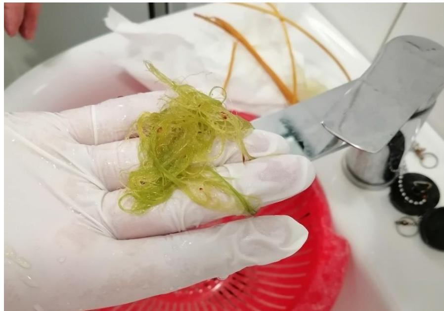
*Slika 38. Odvojena vlakna, spremna za sušenje*
