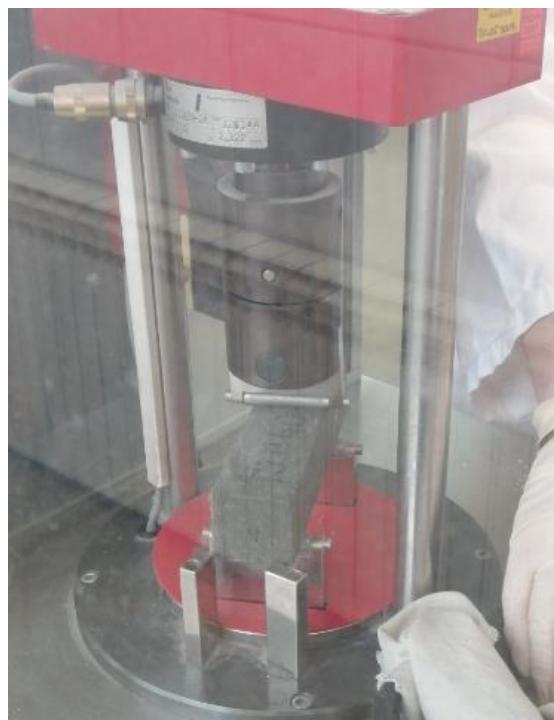
Slika 49. Ispitivanje čvrstoće na vlak (savijanjem)
