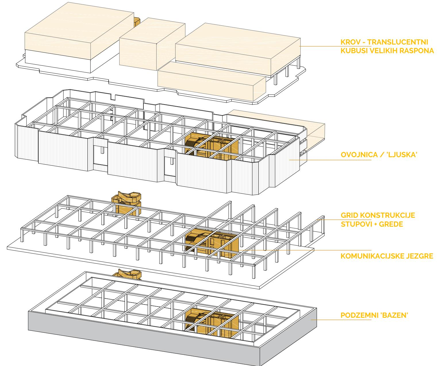
Ostavljajući već postojeću nosivu konstrukciju i betonsku ovojnicu, na krov se dodaju 'kubusi' staklenika koji služe kao reperi u prostoru te postaju aktivna noćna slika grada.
