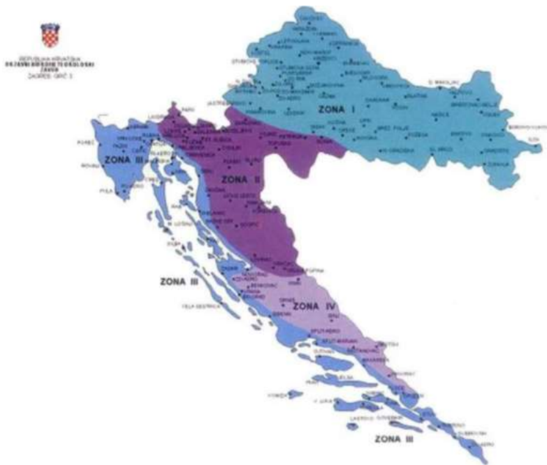
Slika 8.6. Klimatske zone karakterističnog opterećenja snijegom s_k (kN/m 2 )
