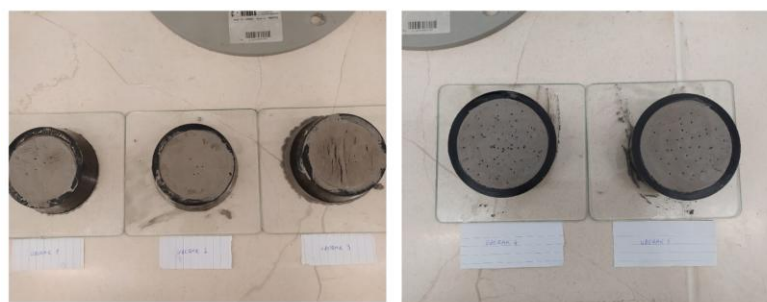
Slika 20. Određivanje vremena vezanja Vicatovim aparatom
