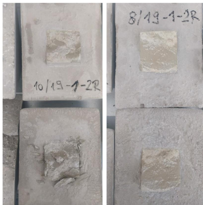
Slika 39. Uzorci 10/19 i 08/19 imobilizirani mortom recepture 2
