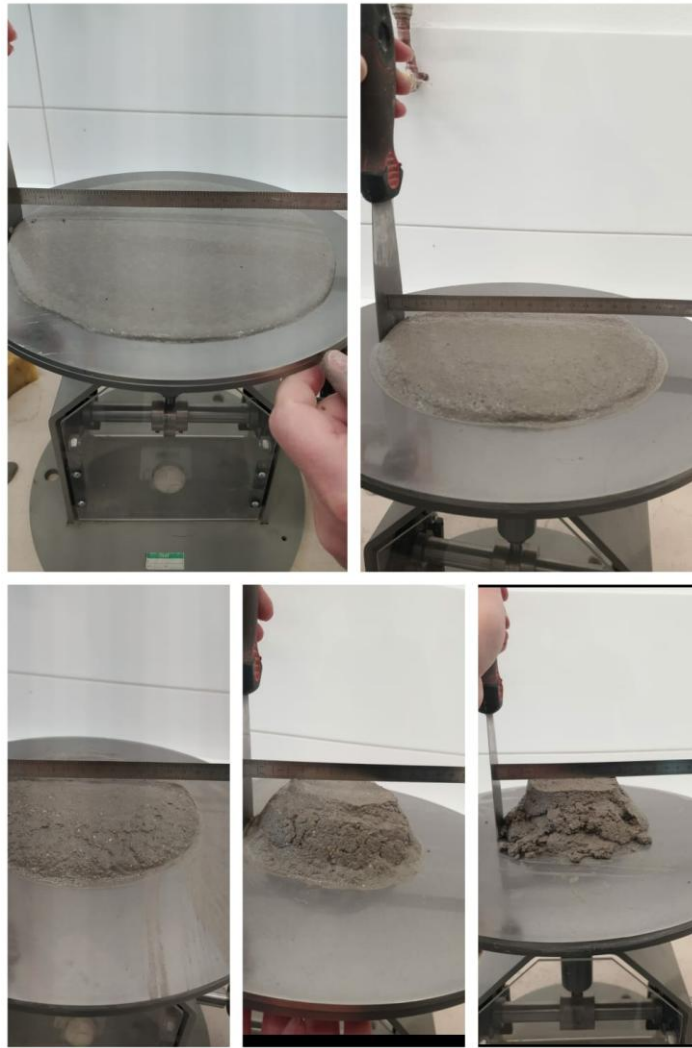
Slika 25. Ispitivanje obradljivosti morta
