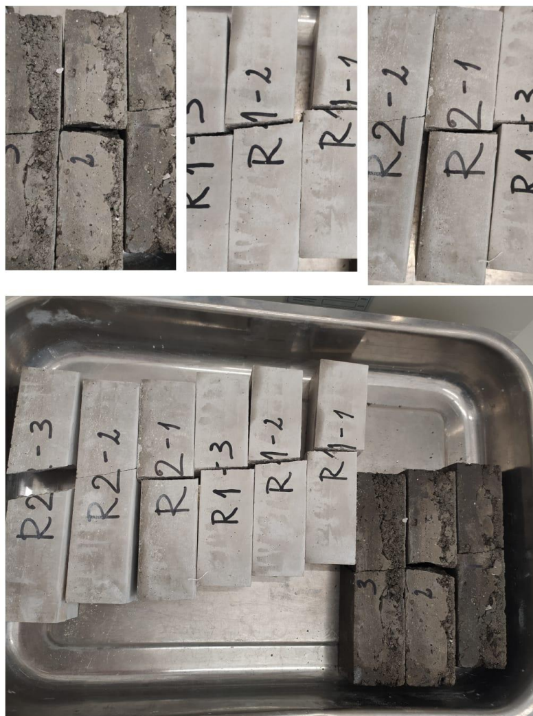
Slika 35. Referentni mort 1, R1 i R2 nakon savijanja
