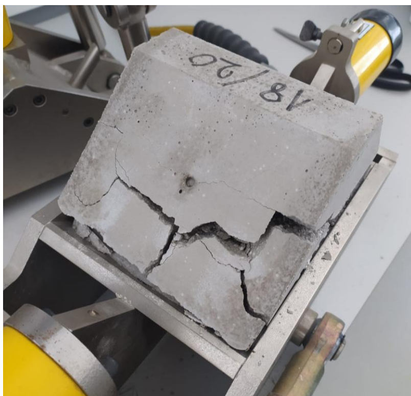
Slika 38. Lom gornje polovice morta kao posljedica momenta savijanja
