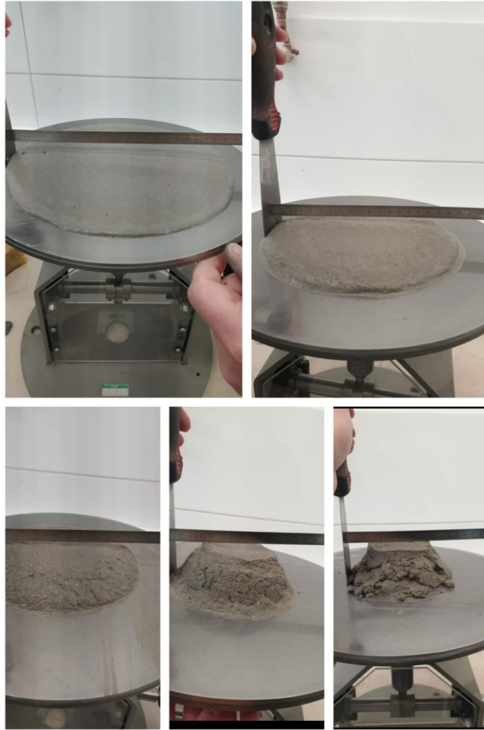
Slika 25. Ispitivanje obradljivosti morta
