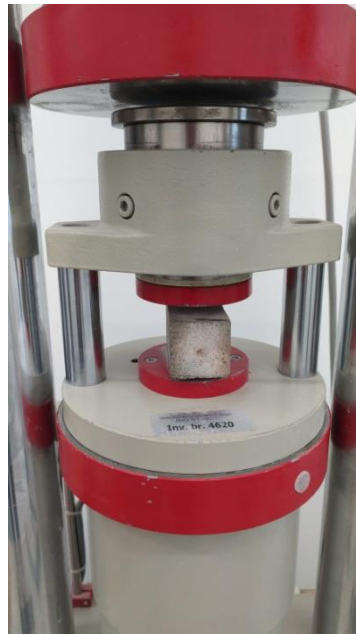
Slika 14. Određivanje tlačne čvrstoće
