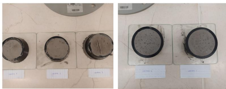
Slika 20. Određivanje vremena vezanja Vicatovim aparatom
