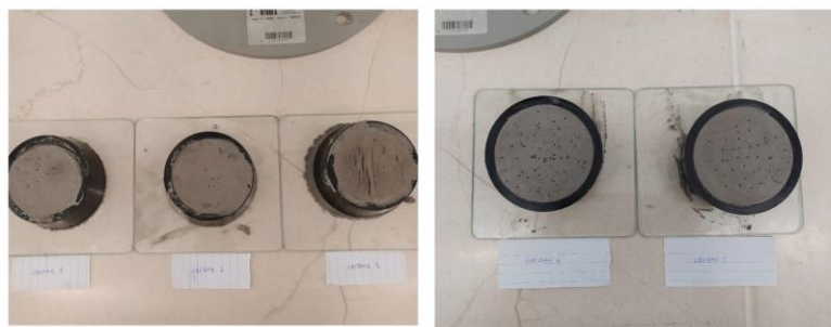
Slika 20. Određivanje vremena vezanja Vicatovim aparatom
