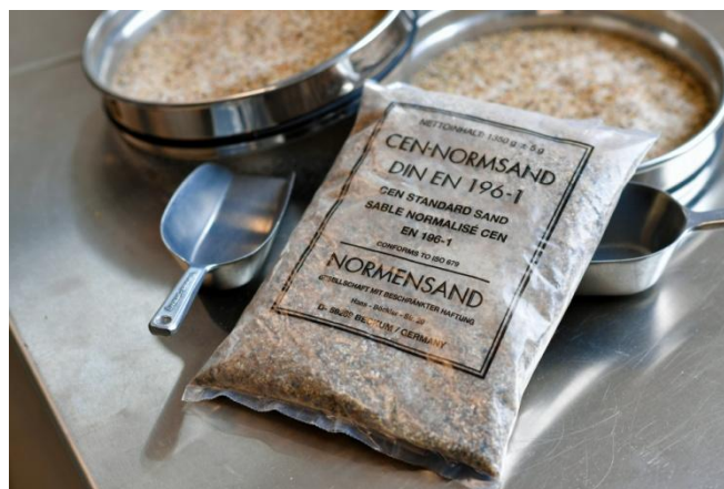
Slika 16. Standardni laboratorijski pijesak
