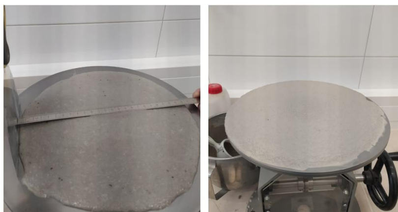
Slika 33. Referentni mort, R1 i R2 na potresnom stolu
