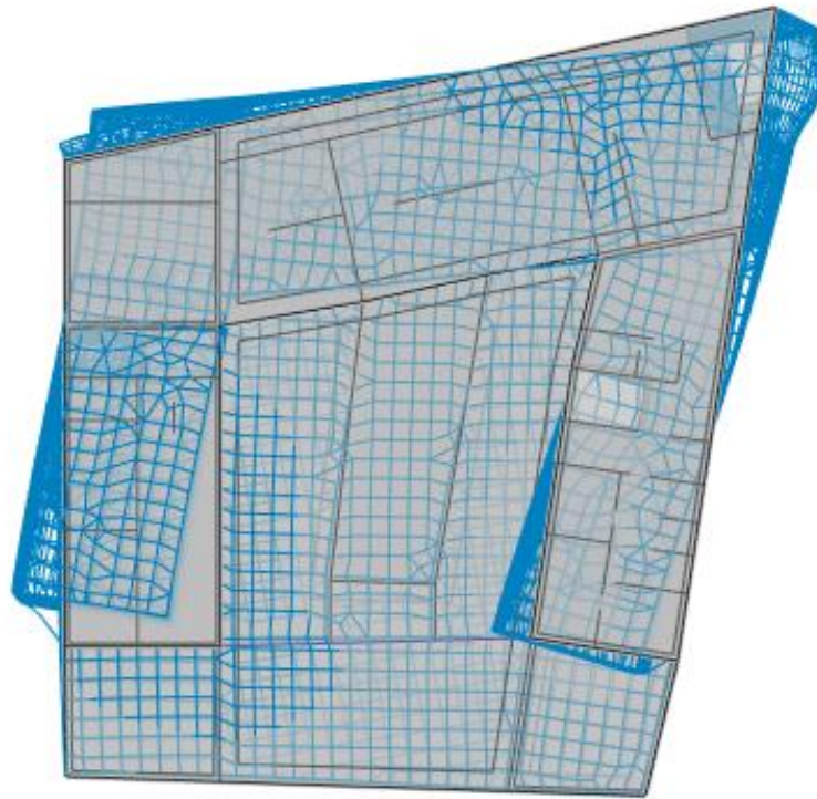
Slika 10.9. Uvrtnje u smjeru globalne osi z
