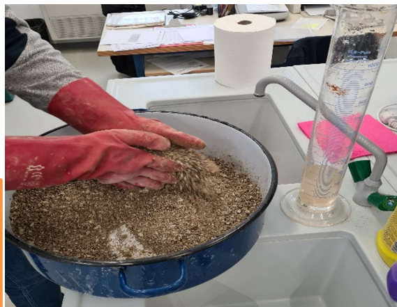
Slika 4.4 Postupak dodavanja vode
