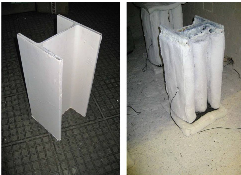
Slika 3.7 Ekspandirajući premaz prije (lijevo) i nakon (desno) djelovanja požara [25]
