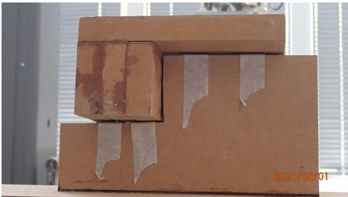
Slika 62: Odizanje poprečnog presjeka kod ležaja
