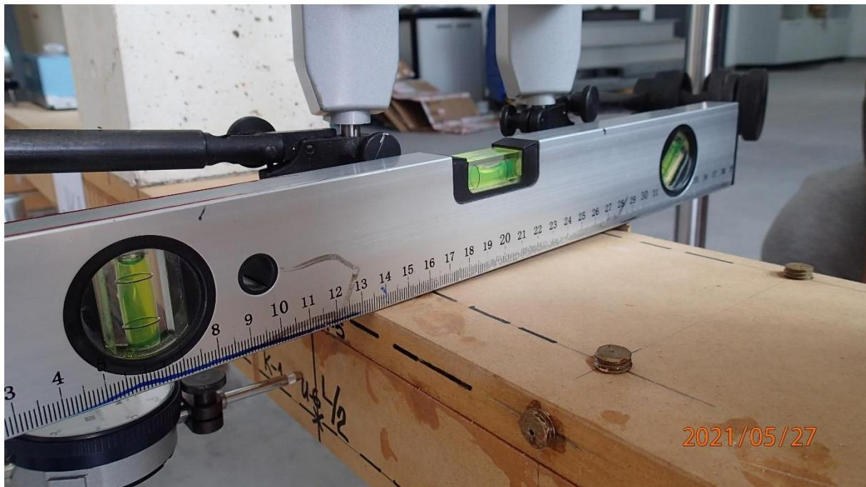
Slika 48: Uvijanje poprečnog presjeka grednog nosača u L/2
