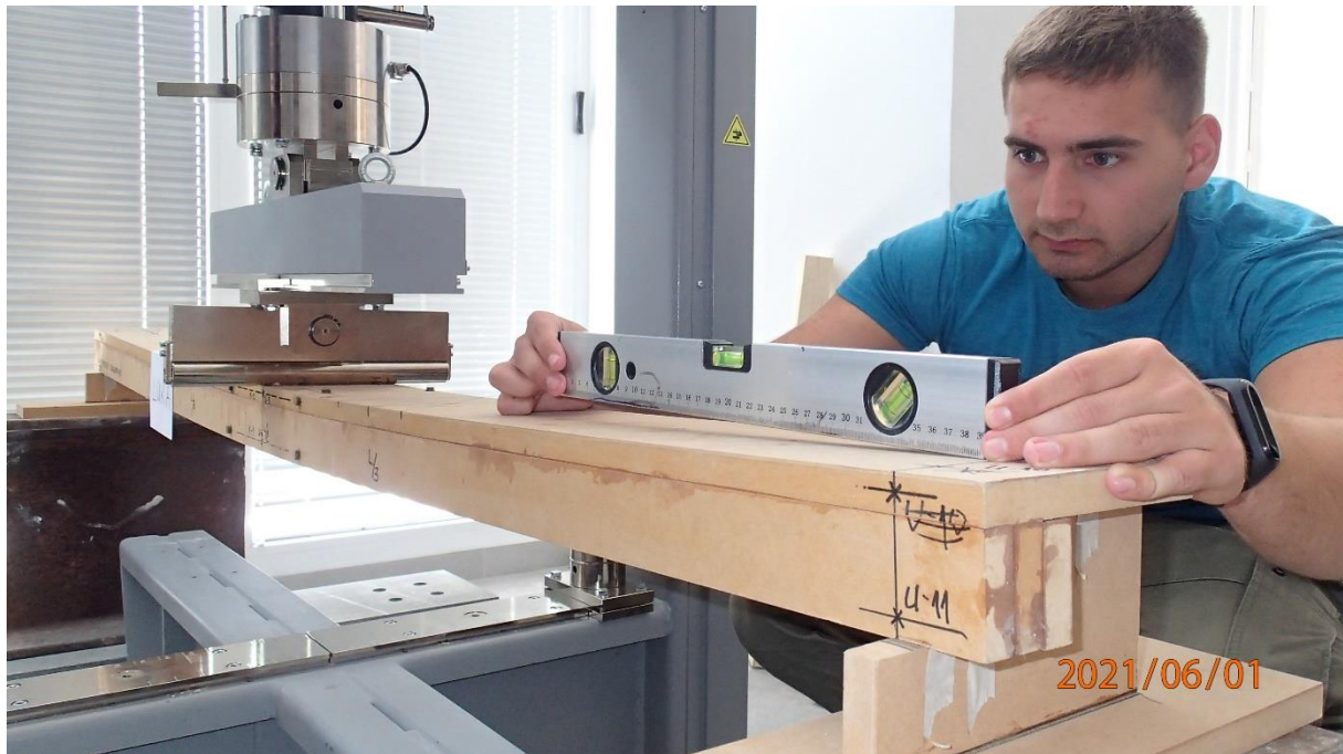
Slika 60: Vidljiva znatna promjena kuta nagiba nosača za silu F = 1,13 \text{ kN}
