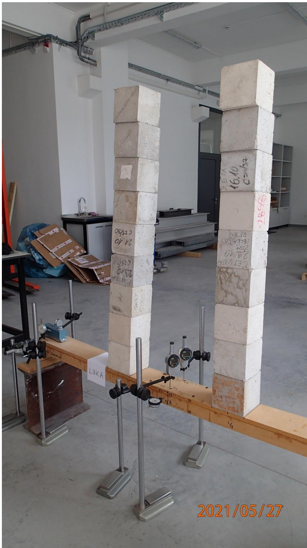
Slika 52: Nosaç s devet redova opterećenja, F = 0,72 kN
