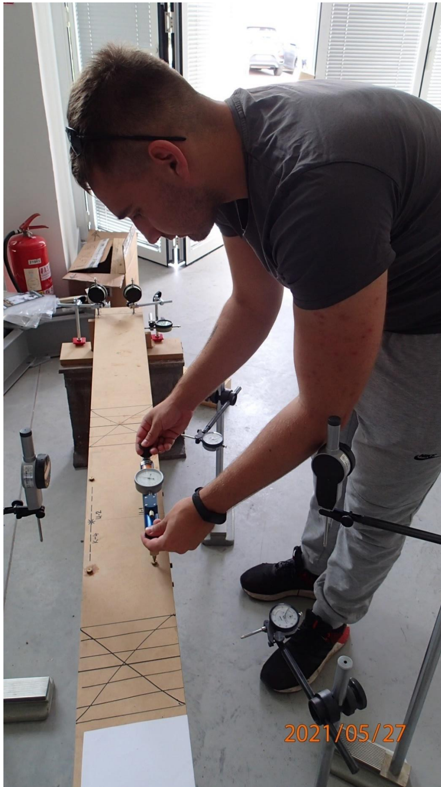
Slika 38: Mjerenje deformacija pomoću Barry-evog prijenosnog komparatora
