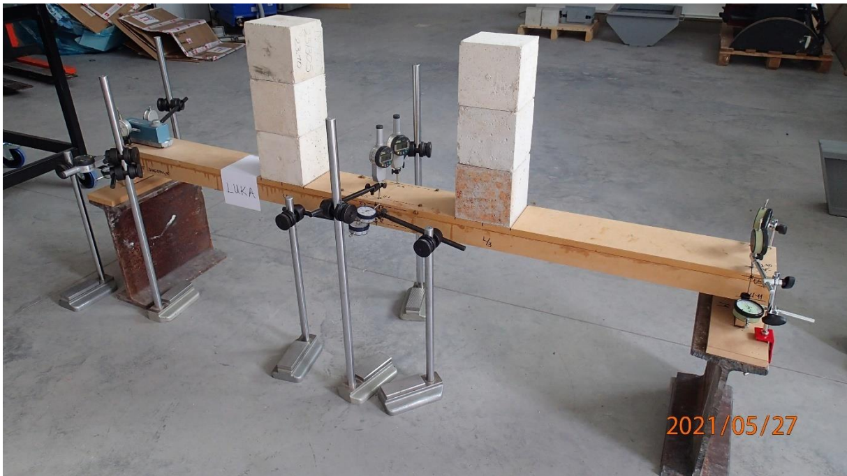
Slika 42: Nosač s tri reda opterećenja, F = 0,24 \text{ kN}
