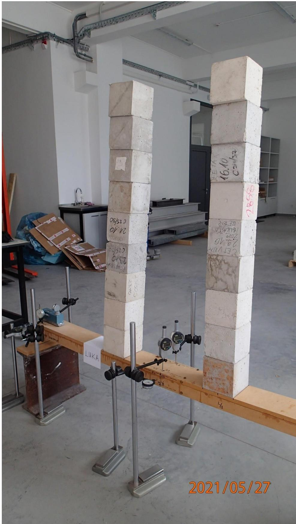
Slika 52: Nosač s devet redova opterećenja,  $F = 0,72 \text{ kN}$
