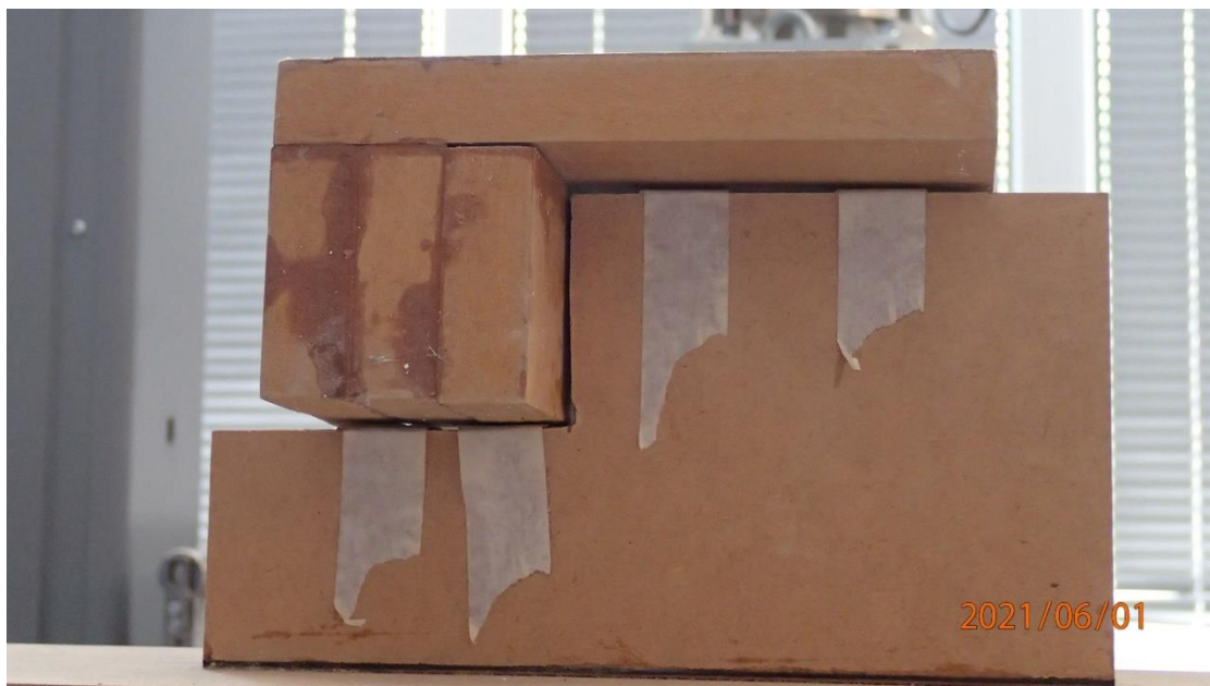
Slika 62: Odizanje poprečnog presjeka kod ležaja
