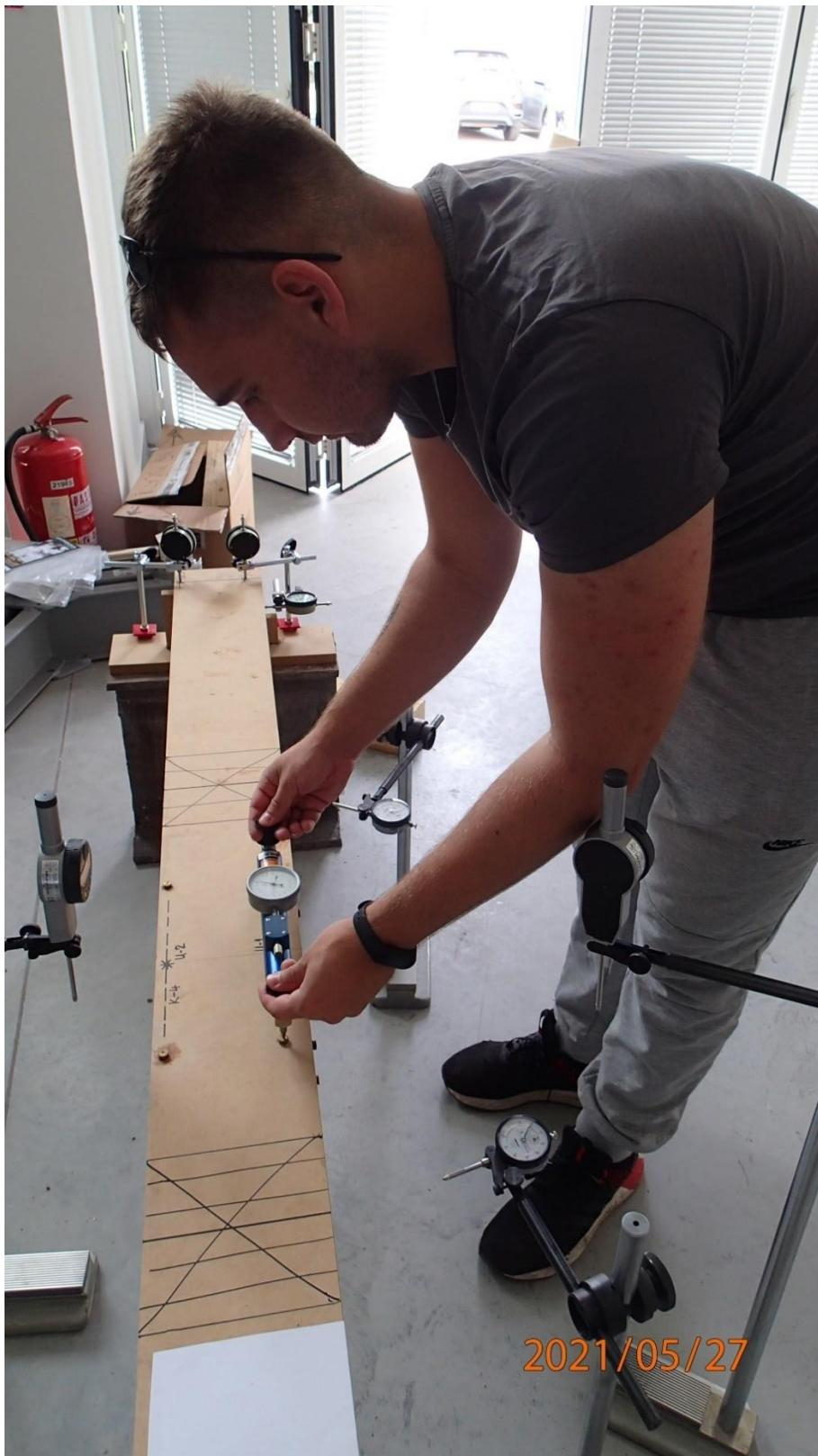
Slika 38: Mjerenje deformatijsa pomoću Barry-evog prijenosnog komparatora
