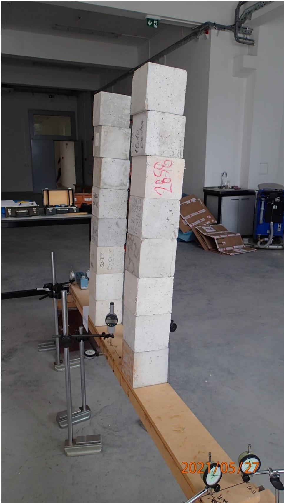
Slika 51: Prikaz uvijanja poprečnog presjeka nosača
