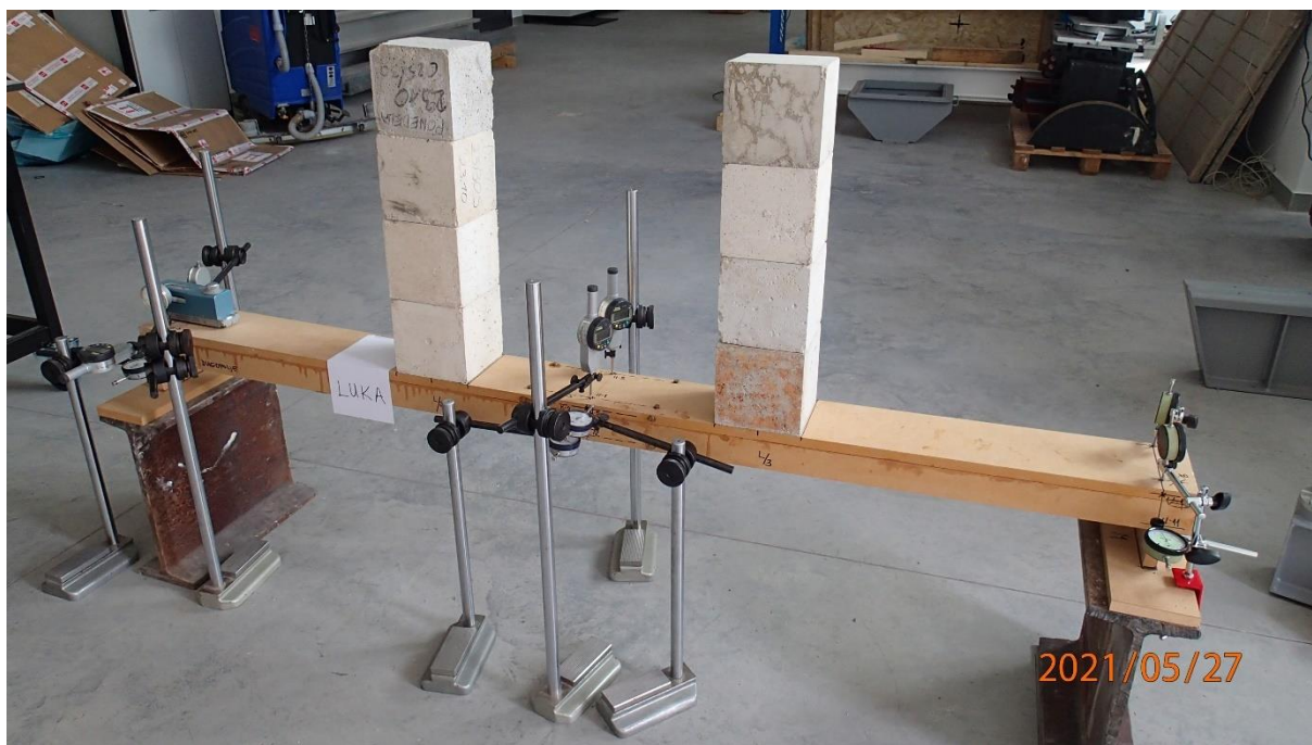
Slika 43: Nosač s četiri reda opterećenja, F = 0,32 \text{ kN}
