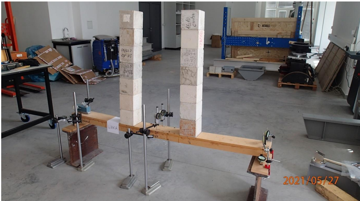
Slika 49: Nosač sa sedam redova opterećenja, F = 0,56\text{kN}
