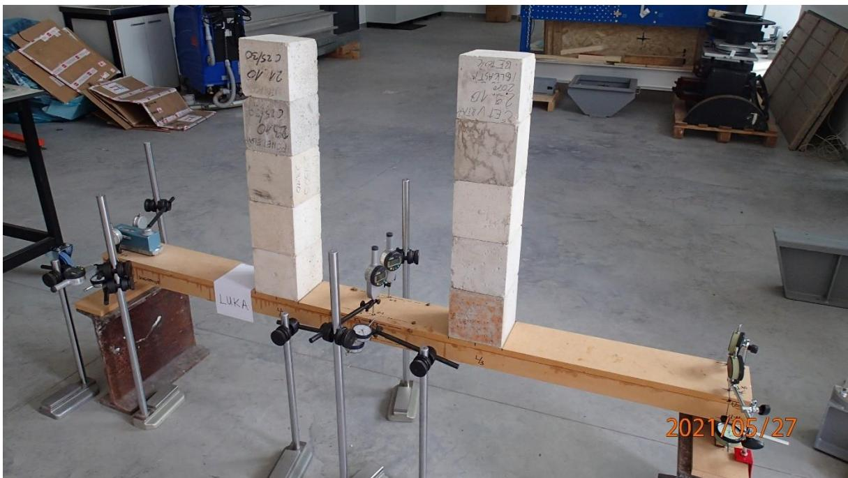
Slika 45: Nosač s pet redova opterećenja,  $F = 0,40 \text{ kN}$
