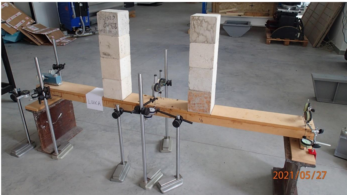
Slika 43: Nosač s četiri reda opterećenja, F = 0,32 \text{ kN}
