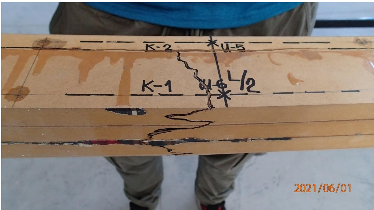
Slika 67: Pukotine na vanjskom licu poprečnog presjeka nosača
