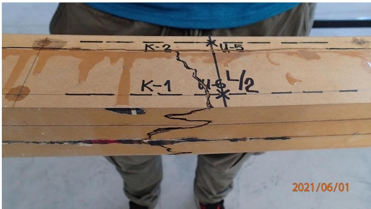
Slika 67: Pukotine na vanjskom licu poprečnog presjeka nosača
