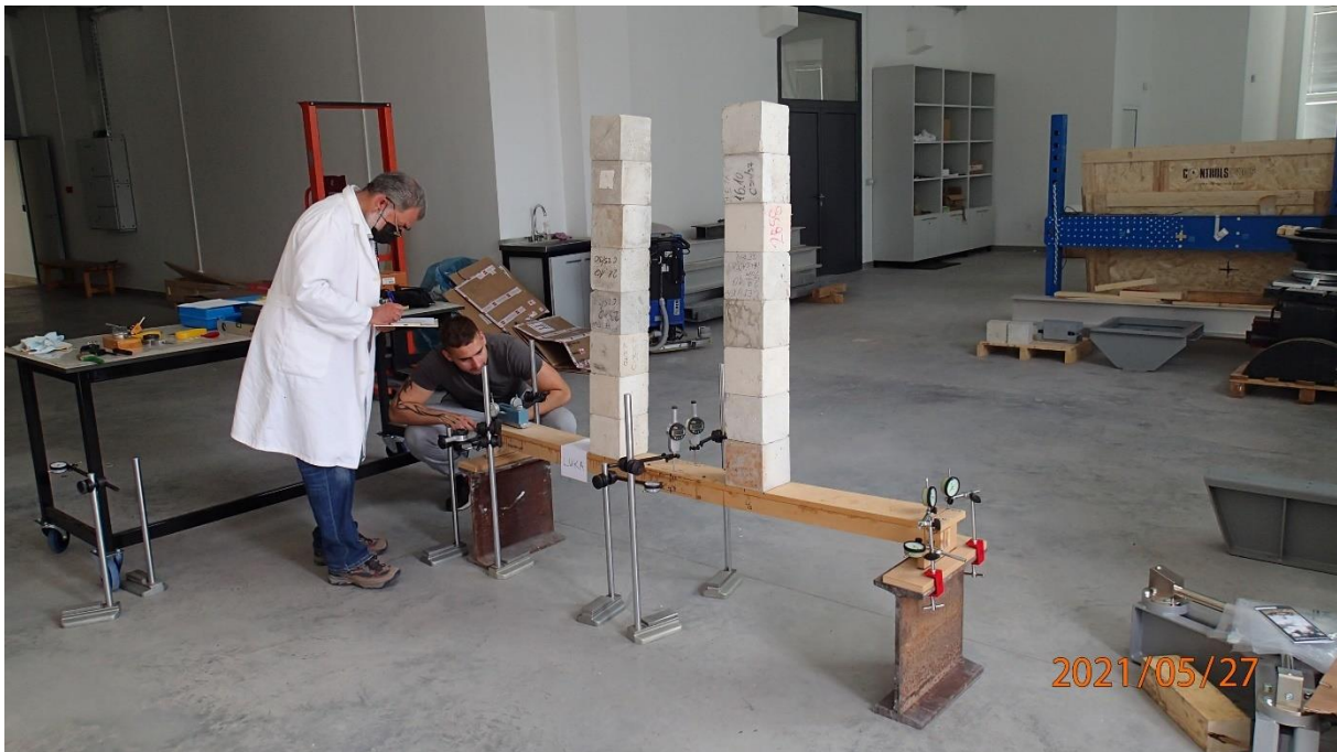
Slika 50: Nosač s osam redova opterećenja, F = 0,64 \text{ kN}
