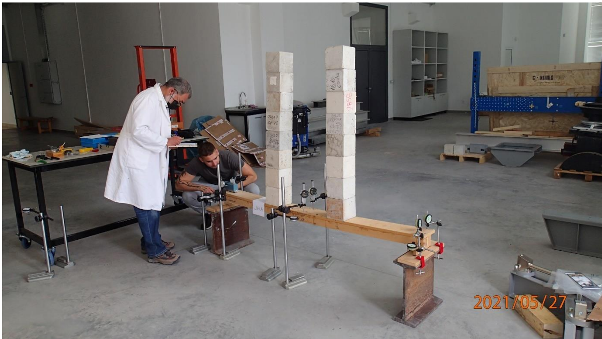
Slika 50: Nosač s osam redova opterećenja, F = 0,64 \text{ kN}
