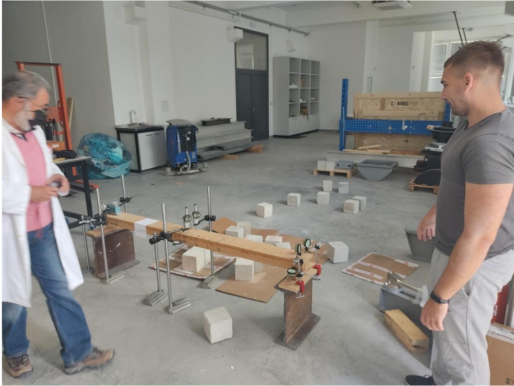
Slika 55: Pad svog opterećenja s nosača
