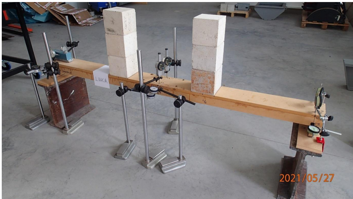
Slika 42: Nosač s tri reda opterećenja, F = 0,24 kN
