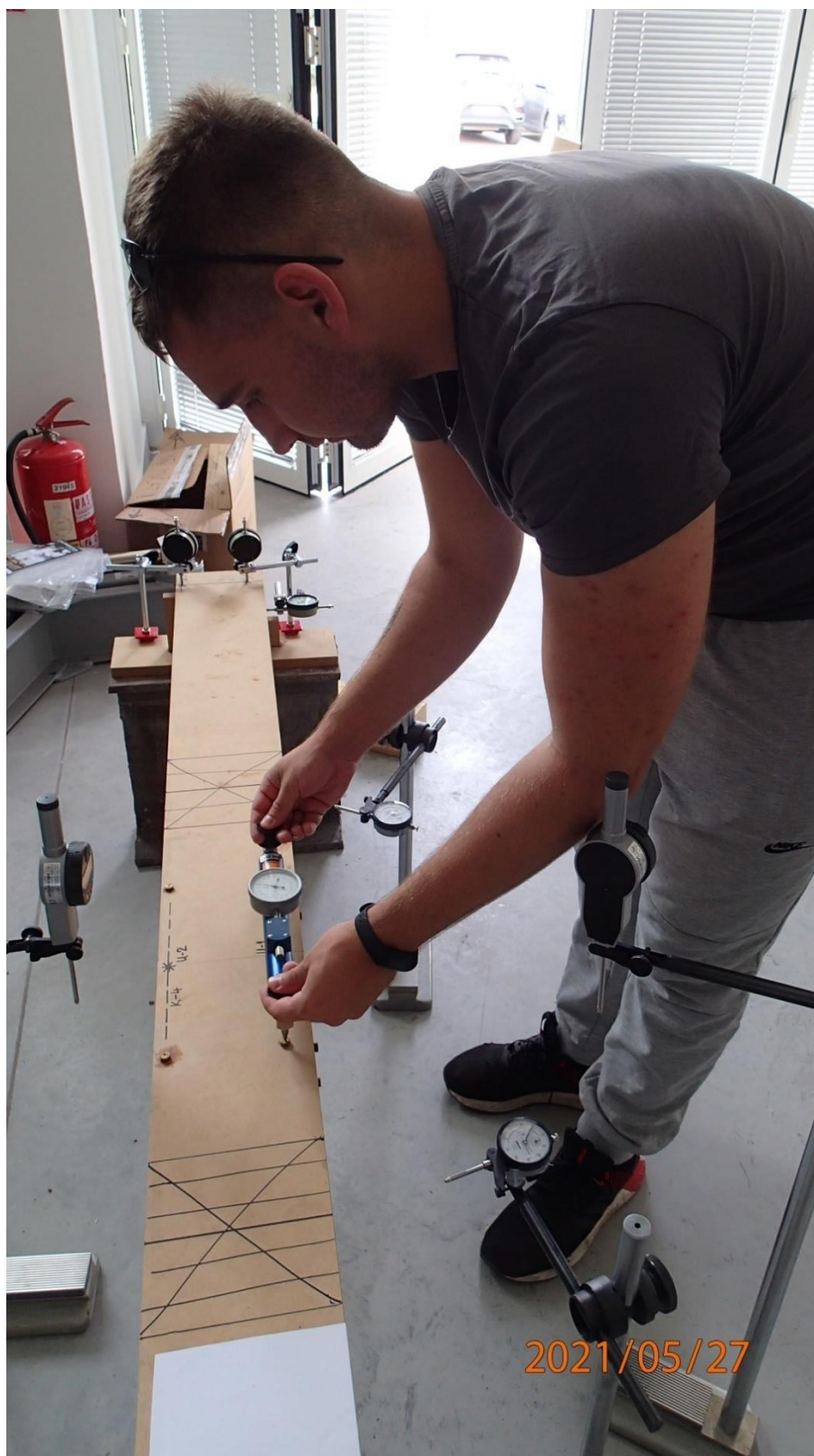
Slika 38: Mjerenje deformacija pomoću Barry-evog prijenosnog komparatora
