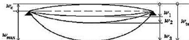
Slika 6.7 Prikaz progiba ploča
