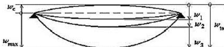
Slika 6.7 Prikaz progiba ploča
