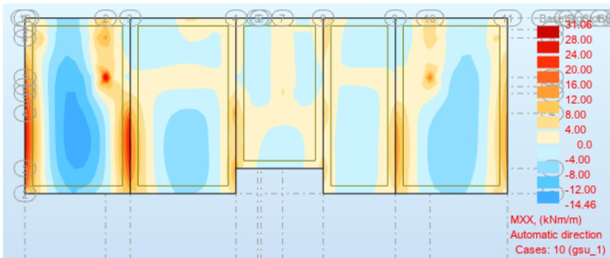
Slika 66.Dijagram momenata savijanja  $M_{ed,x}(\text{kNm}/\text{m})$  za GSU\_1
