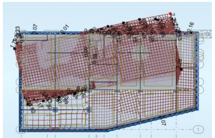
Slika 39. Prikaz trećeg vlastitog vektora, uvrtanje oko globalne osi z
