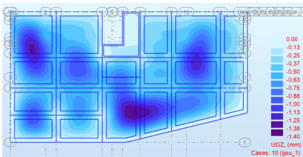
Slika 46. Progi garžne ploče-pozicije 100 za kombinaciju GSU\_1 (mm)
