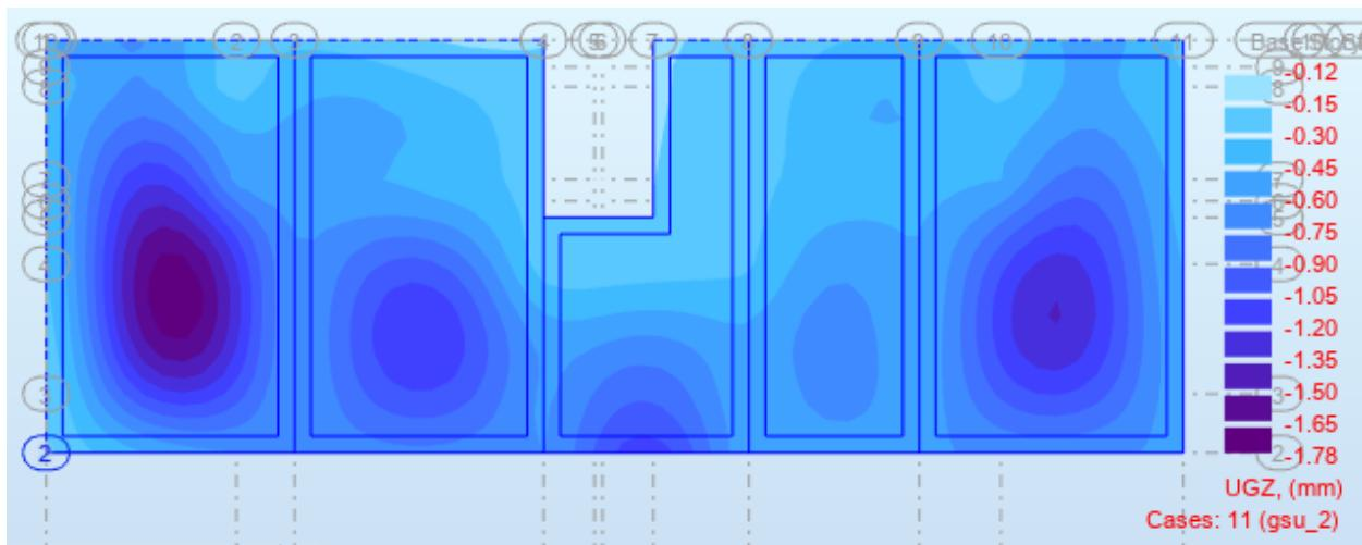
Slika 56. Progi garžne ploče-pozicije 200 za kombinaciju GSU\_2 (mm)
