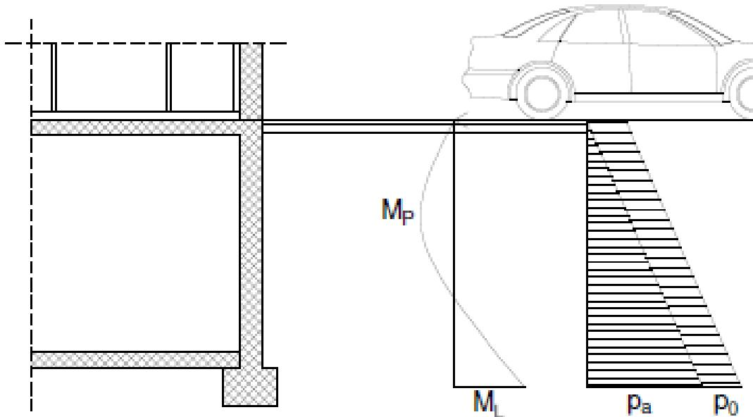
Slika 89. Prikaz opterećenja na obodni zid garaže
