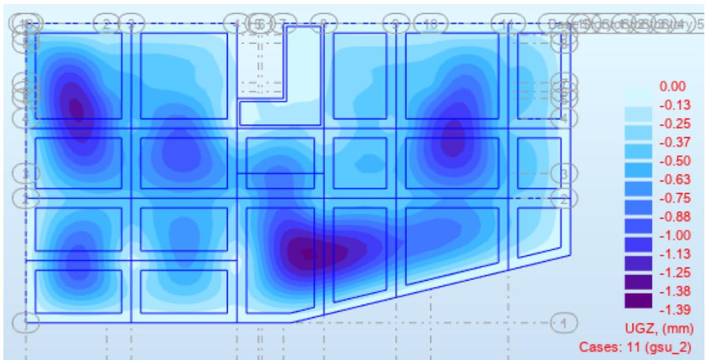
Slika 47. Progi garžne ploče-pozicije 100 za kombinaciju GSU\_2 (mm)
