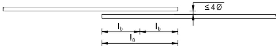
Slika 15. Preklapanje armature
