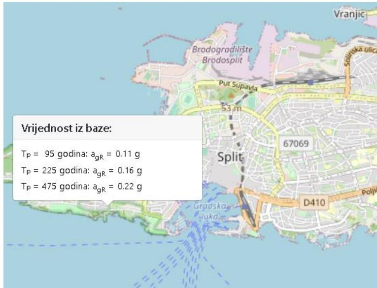
Slika 34. Parametar vršnog ubrzanja tla za promatranu lokaciju
