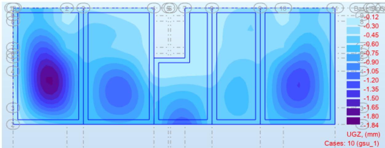
Slika 55. Progi garžne ploče-pozicije 200 za kombinaciju GSU\_1 (mm)
