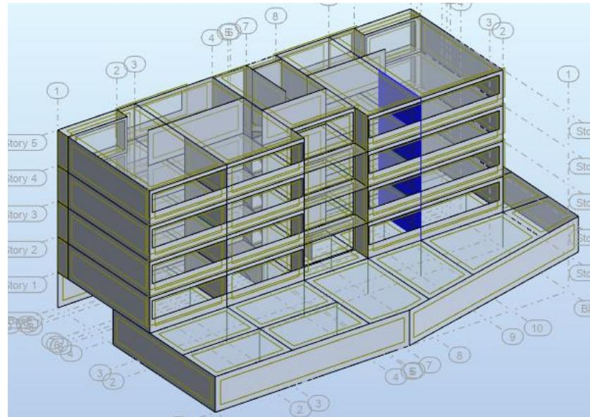
Slika 84.Položaj proračunatog zida u y-smjeru ( 3D model )
