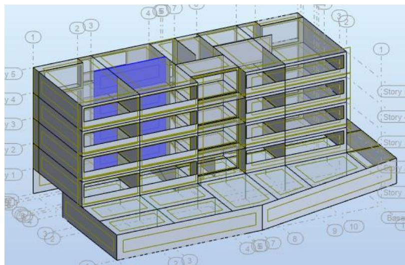
*Slika 79. Položaj proračunatog zida u x-smjeru ( 3D model )*
