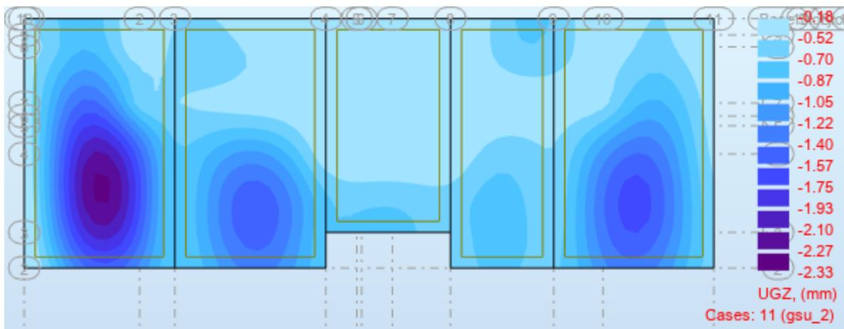
Slika 65.. Progi garžne ploče-pozicije 300 za kombinaciju GSU\_2 (mm)
