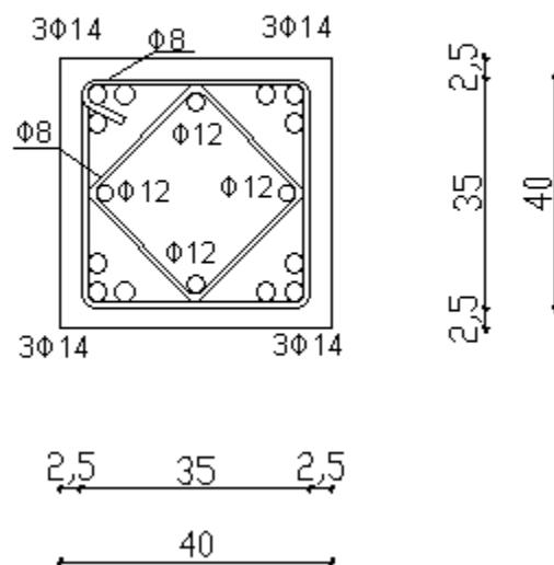
Slika 77. Poprečni presjek stupa sa ucrtanom armaturom
