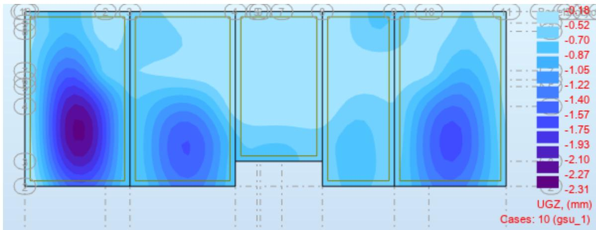
Slika 64. Progi garžne ploče-pozicije 300 za kombinaciju GSU\_1 (mm)
