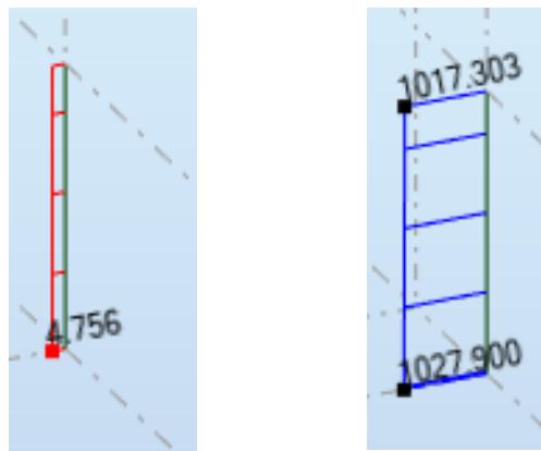
Slika 78. Maximalna poprečna i uzduzna sila stupa
